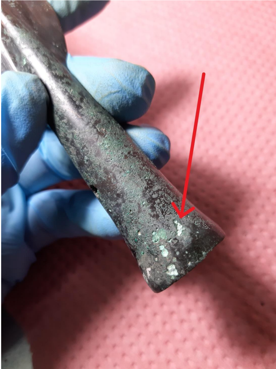
Slika 37. Detalj erupcije paratakamita uslijed raka bronce, snimio: R. Erdelji 2022.
