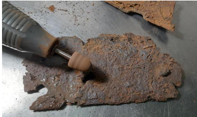
Slika 30. Detalj brušenja smole mikromotorom, snimio: R. Erdelji 2022.
