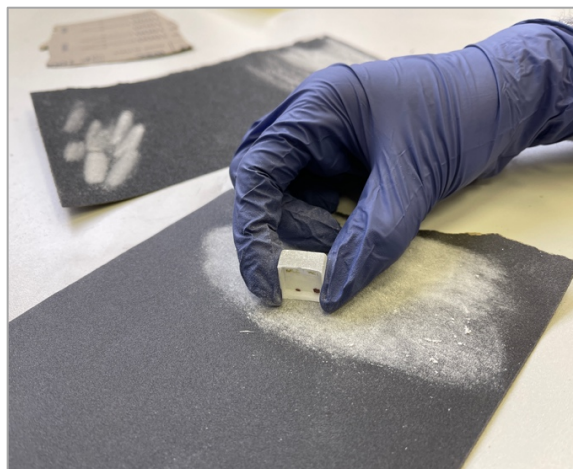
Slika 55. Obrada mikropresjeka brusnim papirom, 2022.
