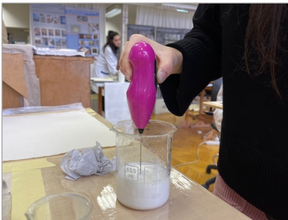
Slika 119. Miješanje ljepila električnom pjenjačom, 2023.
