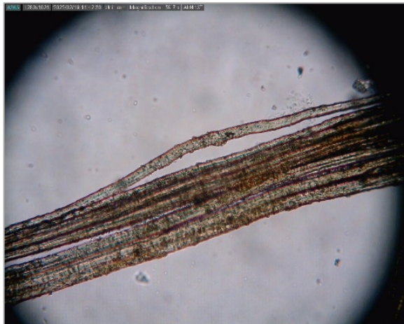
Slika 58. Uzorak platna, vlakna snimljena pod povećanjem 100/400 x, laneno platno, 2022.
