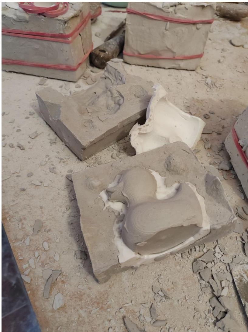
Slika 13 - Lijevanje gipsanih patkica iz silikonskih kalupa
