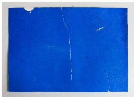
Slika 80: Rezultat proba podljepljivanja na testnom uzorku sitotiska, na lijevoj polovici je korišteno celulozno ljepljivo ( Tylosa MH 300 ), a na desnoj industrijsko škrobno ljepljivo, prednja strana (fotografirala Alma Šarić 27. 3. 2023.)
