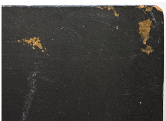
Slika 134: Detalj prije reintegracije crnog sloja na lesnitnoj podlozi (fotografirala Alma Šarić 4. 3. 2023.)
