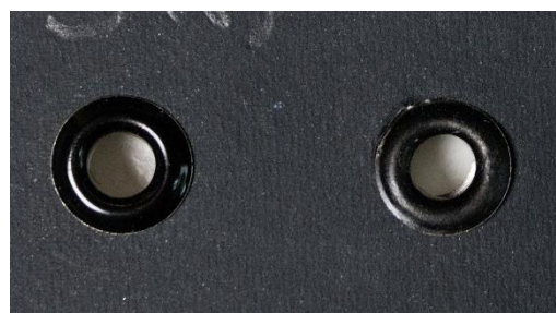
Slika 90: Rezultati proba lakiranja metalnih spojnice, lijevo je lak visokog sjaja, desno je mat lak (fotografirala Alma Šarić 30. 3. 2023.)
