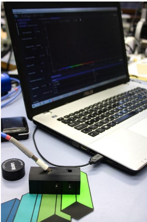
Slika 63: FORS analiza na mobilnom elementu br. 12 prije uklanjanja površinske prljavštine (fotografirala Alma Šarić 21. 3. 2023.)
