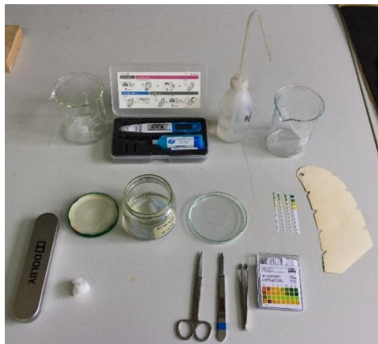
Slika 57: Alat i materijal korišten pri mjerenju kiselosti papira (fotografirala Alma Šarić 27. 3. 2023.)
