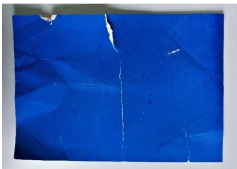
Slika 78: Simulacija nabora, poderotina i pregiba na testnom uzorku sitotiska, prednja strana (fotografirala Alma Šarić 27. 3. 2023.)
