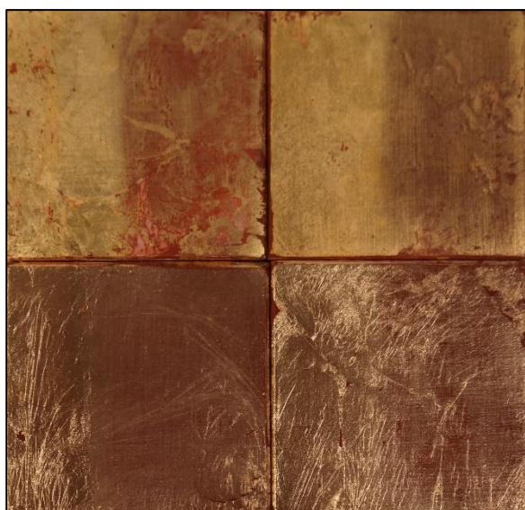
Slika 77. Probe boja različitih vrsta zlatnih listića, 1.) Dukaten dopel gold 23K, 2.) Rosenoble dopel gold 23.75K, 3.) Versailles gold extra dunkel 23K, 4.)Dukaten antik gold P1 23.6K
