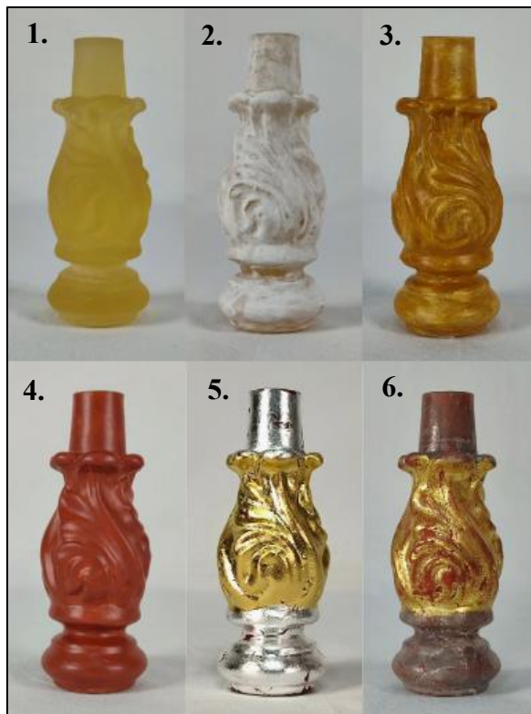
Slika 81. Prikaz 3D printanog članka svijećnjaka u svim fazama rada, 1.) 3D printani članak, 2.) bijeli poliment, 3.) žuti poliment, 4.) crveni poliment, 5.) zlatni i srebrni listići, 6.) patiniranje i postarivanje
