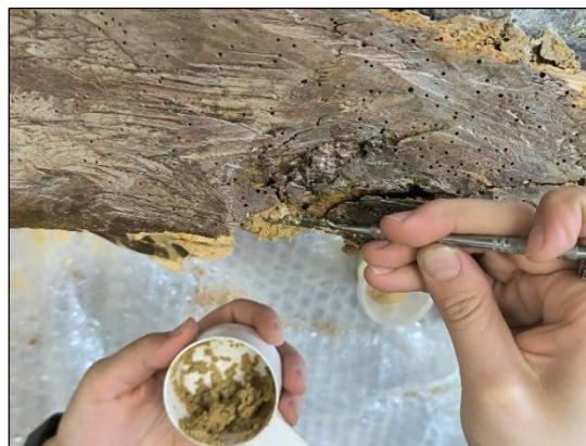
Slika 122. Proces nadoknade oštećenja u sloju drvenog nosioca piljevinskim kitom napravljenim s vezivom Bison Wood Glue D2 , fotografirala: S. Knežević, svibanj 2024.
