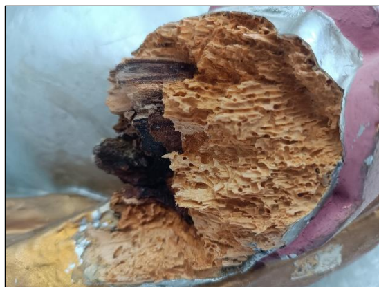
Slike 31. i 32. Struktura drvenog nosioca nakon dijelovanja, Martin Mittermayr, skulptura sv. Ladislava, 18. st. fotografirala: S. Knežević, ožujak 2024.
