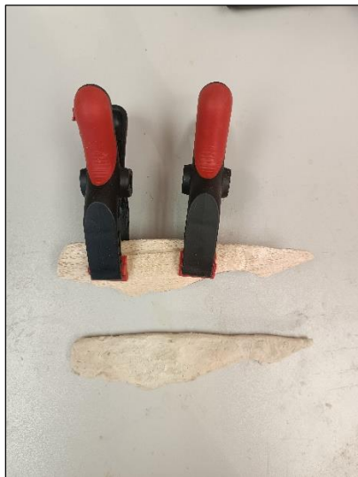
Slika 153. Spajanje dviju letvica PVAc Bizon Wood glue D2 ljepilom u jednu cjelinu, fotografirala: S. Knežević, svibnja 2023.
