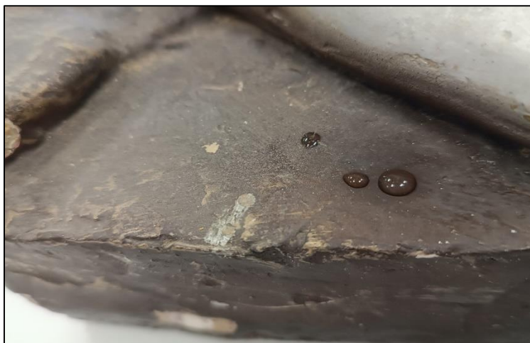
Slika 79. Određivanje vrste površine uz pomoću kapljive vode, fotografirala: S. Knežević studeni 2023.
