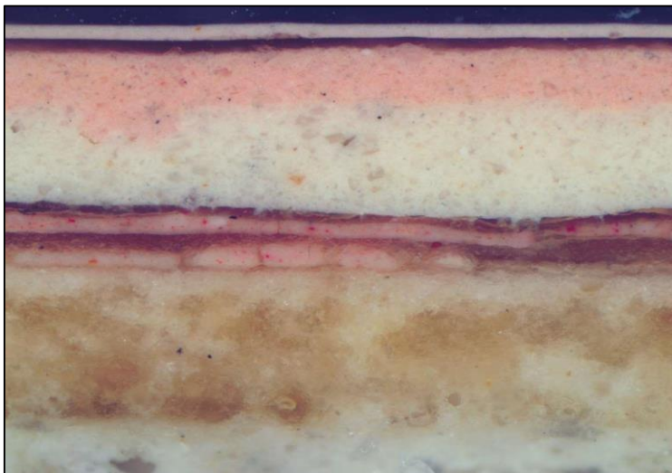
Slika 70. Mikropresjeka uzorka 4 P=100×, snimila: dr.sc. T. Z. Ferri, Archeolab,2023. 34
