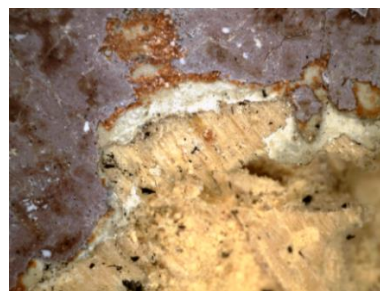
Presjek: nosilac/drvo, kredno tutkalna osnova, crveni oslik, crveni preslik
