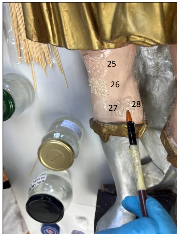
Slike 231. - 232. Postavljanje gelova i ispitivanje njihove učinkovitosti za uklanjanje preslika na inkarnatu: 24- etanol geliran s Klucelom G , 25- Dowanol PM , 26 geliran u Klucelu G - etil laktat geliran s Klucelom G , 27- benzil alkohol geliran s Klucelom G , skulptura sv. Ladislava, radna fotografija, fotografirala: A. Božičević, studeni 2023.
