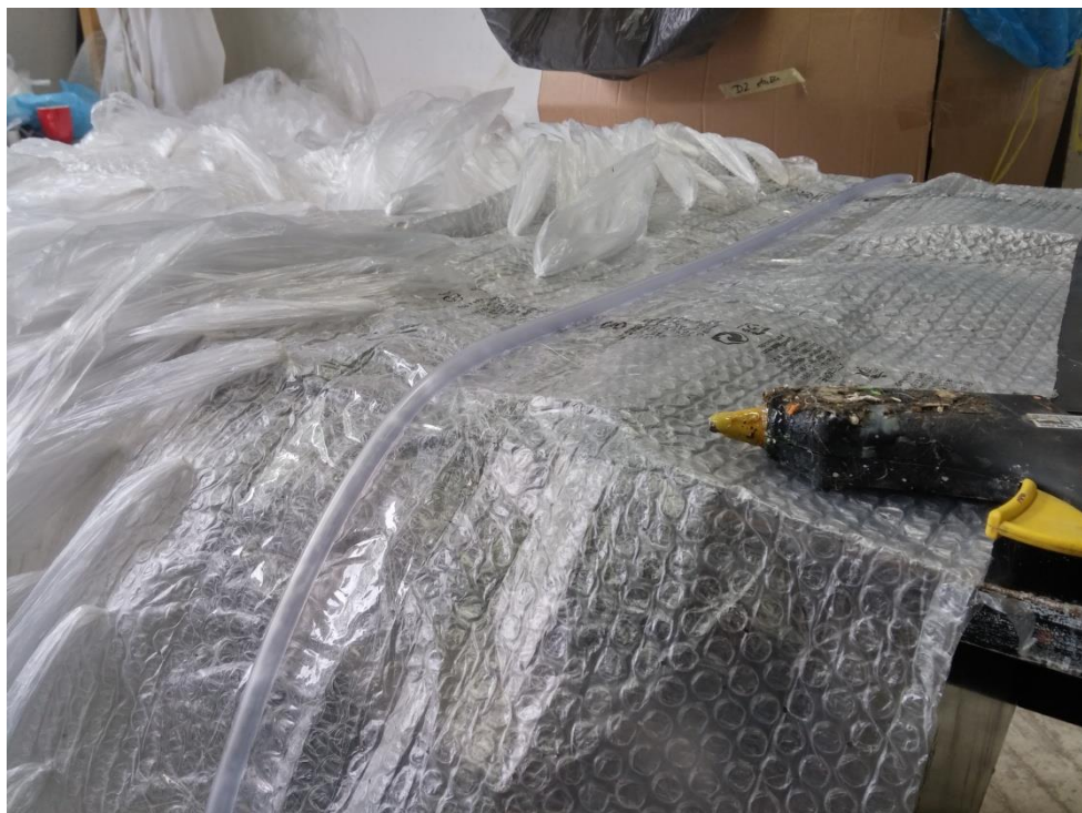
Fotografija 24: Prozirna gumena cijev zalijepljena za platu ojačanu prozirnrom ljepljivom trakom
