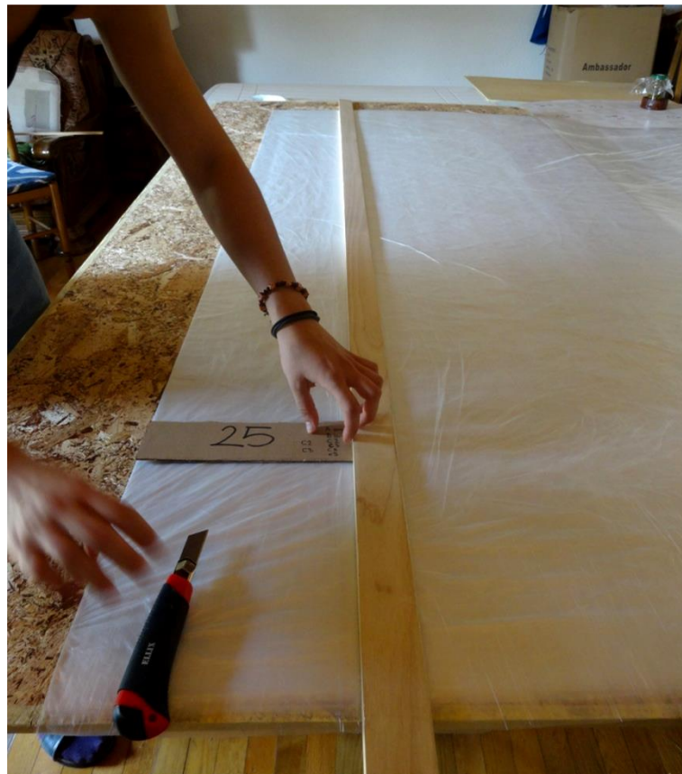
Fotografija 11: Mjerenje potrebne širine najlona prije rezanja
