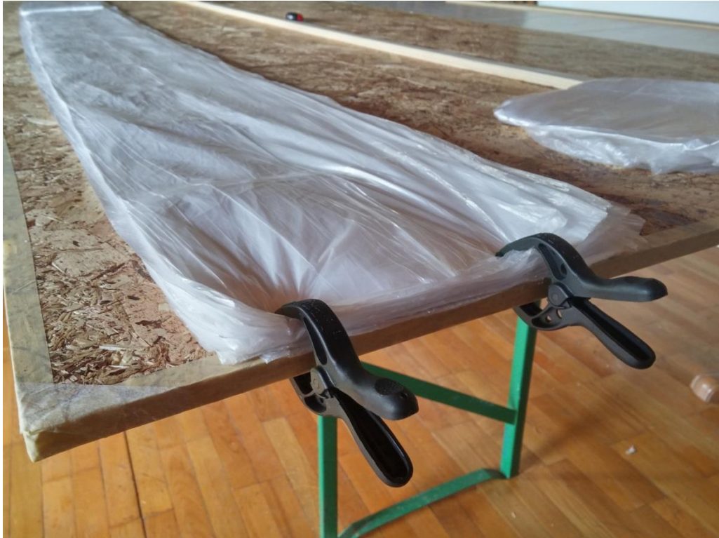
Fotografija 14: Slojevi traka spremnih za rezanje
