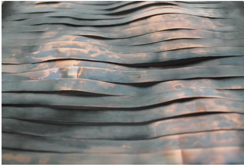
slika – primjer iskucane bakrene ploče drvenim puncama
