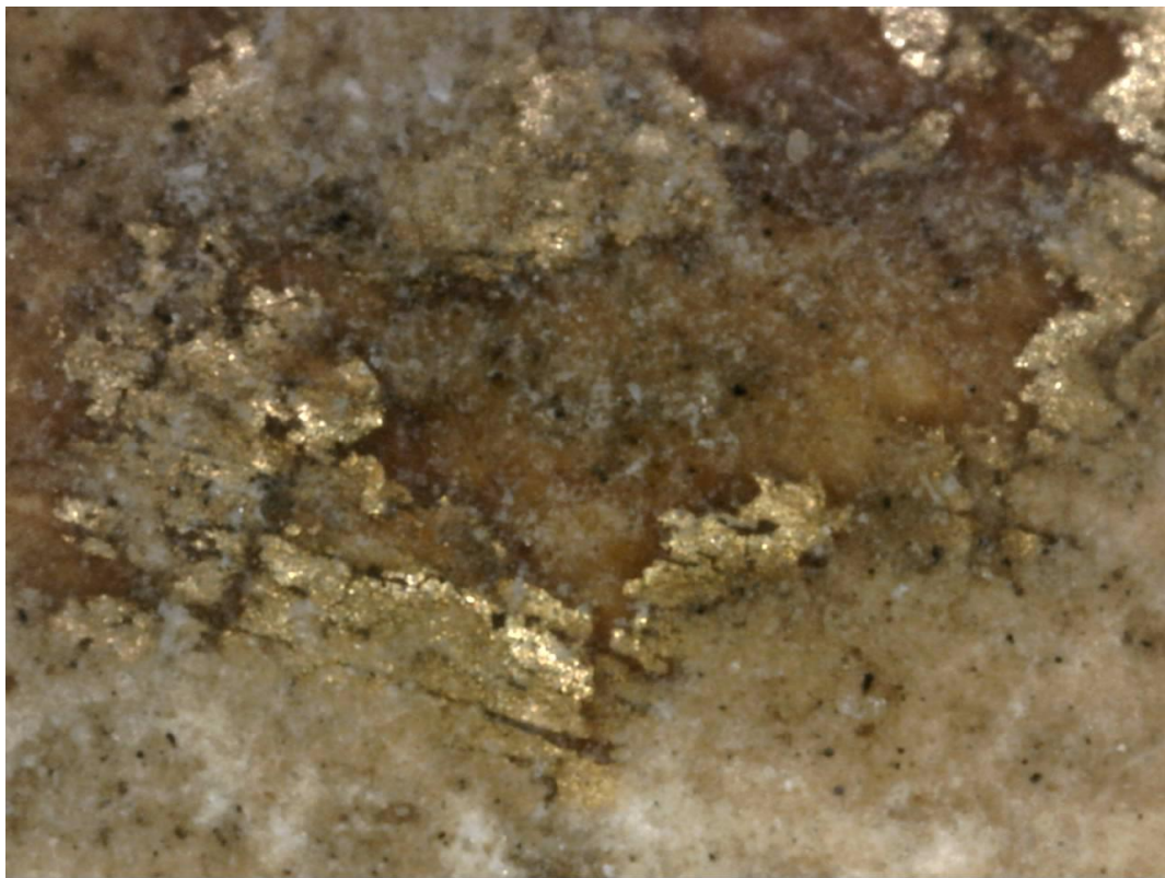
Slika 80. Pozlata ispod sloja kredno-tutkalne osnovne II. kronološkog sloja, detalj, snimak Dino-lite mikroskopom
