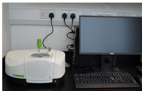
Sl. 24. FTIR uređaj spojen s računalom (Perkin Elmer Spectrum Two FTIR)
