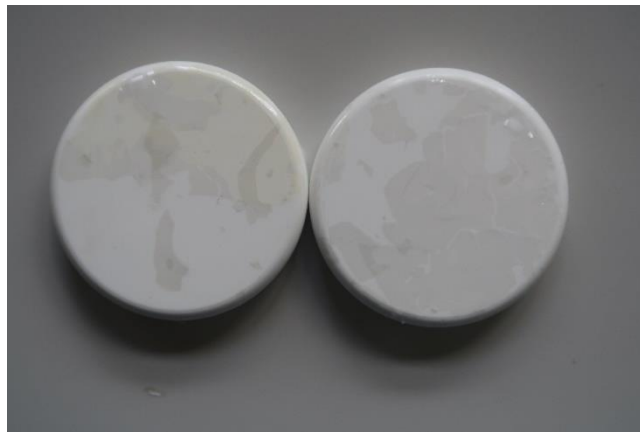
Sl. 69. uzorci arapske gume ozračeni dozom od 25 kGy, lijevo – zračenje manjom brzinom doze zračenja ( \dot{D} = 69,98 \text{ mGy/s} ), desno – zračenje maksimalnom brzinom doze zračenja ( \dot{D}_{\text{max}} = 7,695 \text{ Gy/s} )
