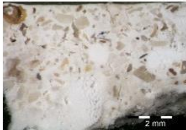
Slika 1. Mikrofotografija poprečnog presjeka uzorka žbuke lab broj 20734
