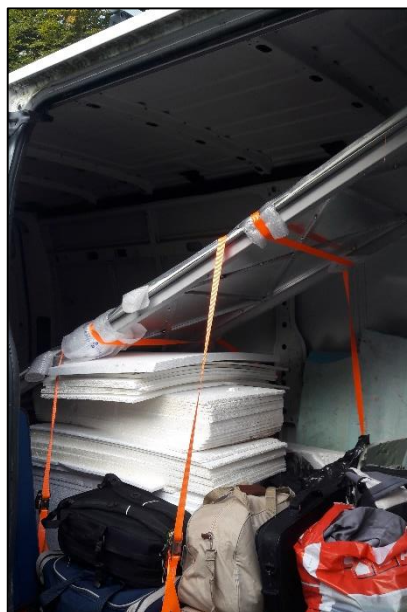
Slika 135. Osiguravanje transfera od mogućeg pomicanja prilikom transporta
