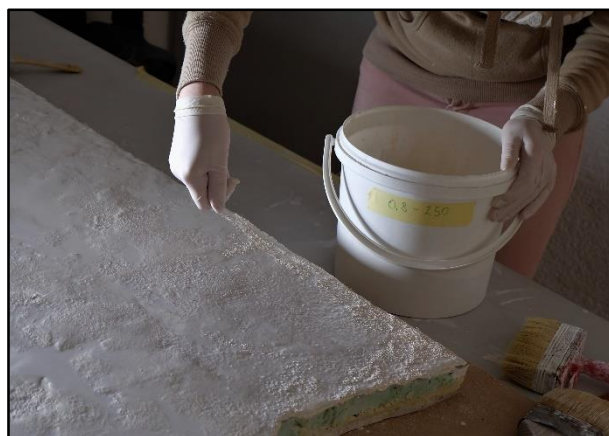
Slika 108. Dodatno posipavanje nakon stvaranja „jezerca“ vapnenog kazeinata
