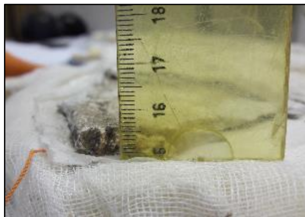
Slika 71. Mjerenje debljine žbuknog sloja intonaco ravnalom
