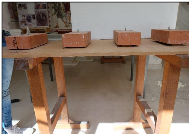
Slika 97. Debljina nanošenja PUR pjene pomoću distancera
