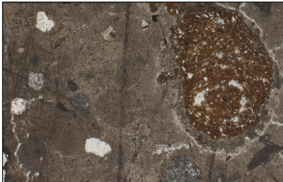
Slika 6. Mikrofotografija iz poliranog tankog presjeka uzorka 1. Transmisijsko svjetlo usporedni polari
