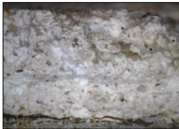
Slika 72. Detalj, uvećana fotografija stratigrafije žbukanih slojeva (presjek)
