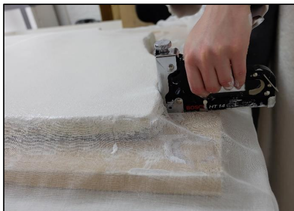
Slika 113. Napinjanje pamučne gaze
