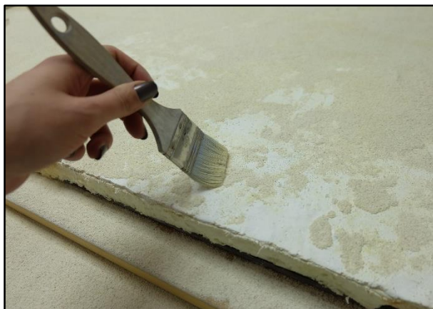
Slika 110. Otprašivanje viška pijeska pomoću kista
