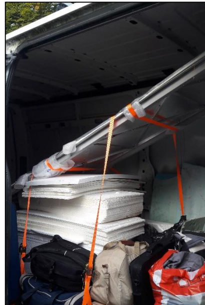
Slika 135. Osiguravanje transfera od mogućeg pomicanja prilikom transporta
