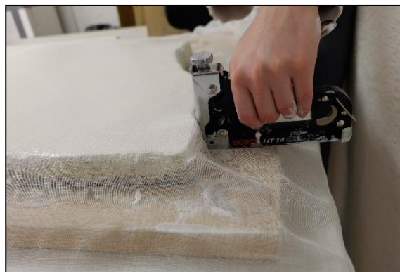
Slika 145. Fiksiranje netom položene gaze klamericama za čvrstu podlogu.
