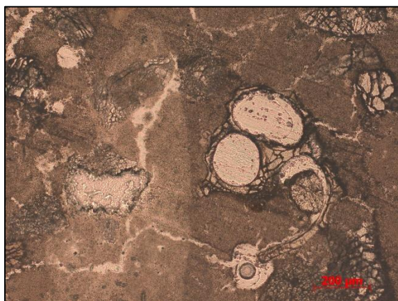
Slika 13. Mikrofotografija ispoliranog tankog presjeka uzorka 3. Transmisijsko svjetlo, usporedni polari.
