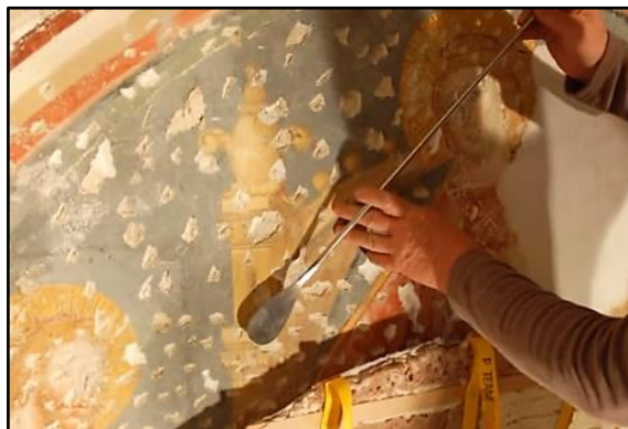
Slika 12. Primjer metalnog alata za odvajanje zidnih slika, oble glave. Na kraj metalne šipke zavaren je vrh oble špahtle.
