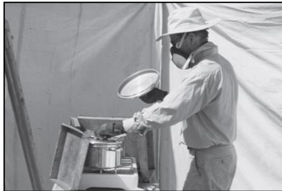
Slika 40. Zagrijavanje ciklododekana u prijenosnoj posudi s dvostrukim dnom (i zaštita od vjetra platnenom konstrukcijom).
