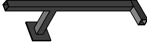
cijev 35X35 3mm debljine
