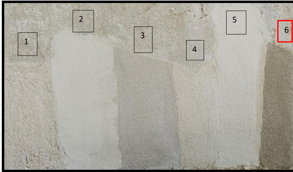
Slika 82 Detalj, proba žbuka na novijem sloju
