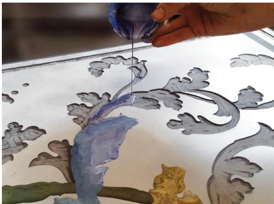
Sl. 142 – Ulijevanje smjese u izdubljenu površinu
