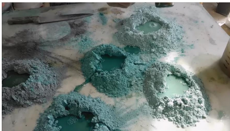
Sl. 133 - Pripremljene mješavine pigmentiranog gipsa i tutkala
