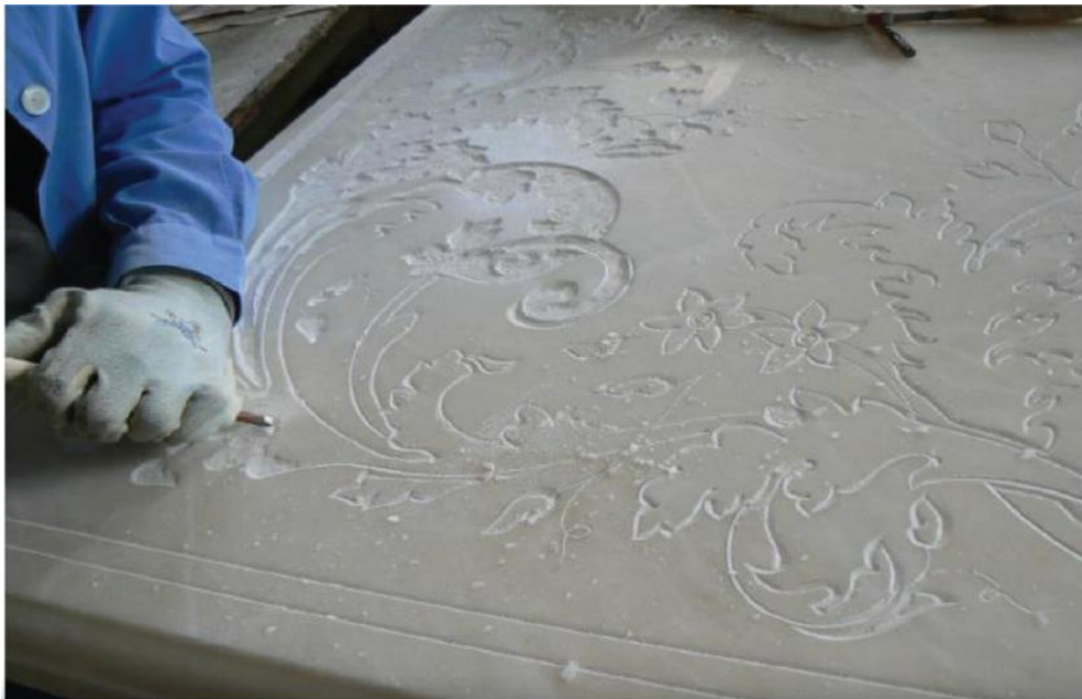
Sl. 141 – Urezivanje uzorka u podloženu smjesu
