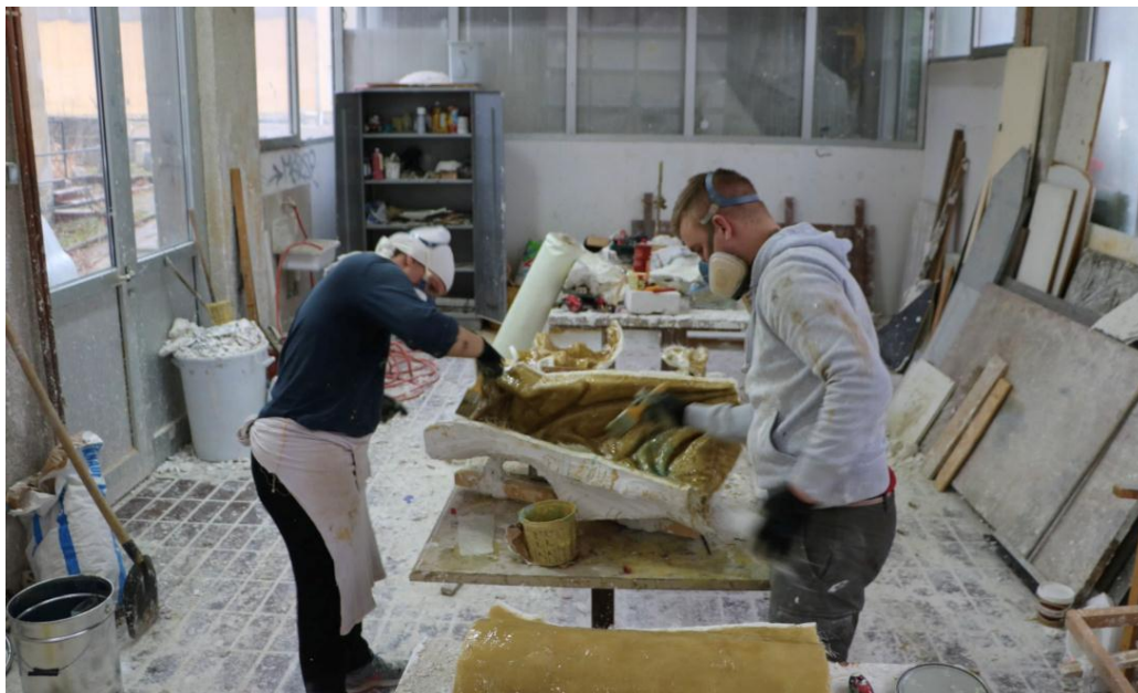
Slika 109: Nanošenje drugog sloja sa staklenim matom
