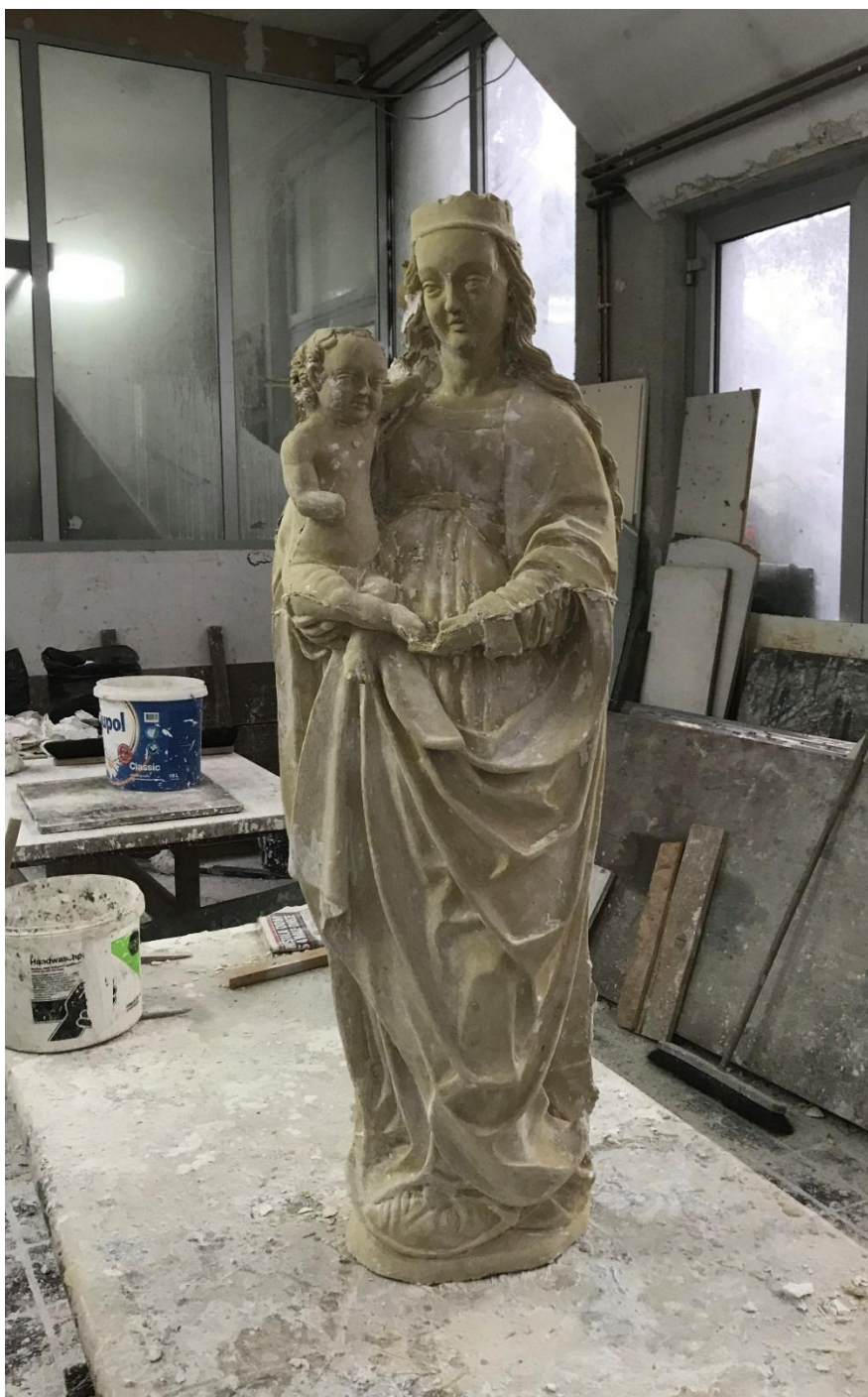
Slika 115: Pozitiv kopije skulpture „Bogorodica s Djetetom“ odliven u poliesterskoj smoli
