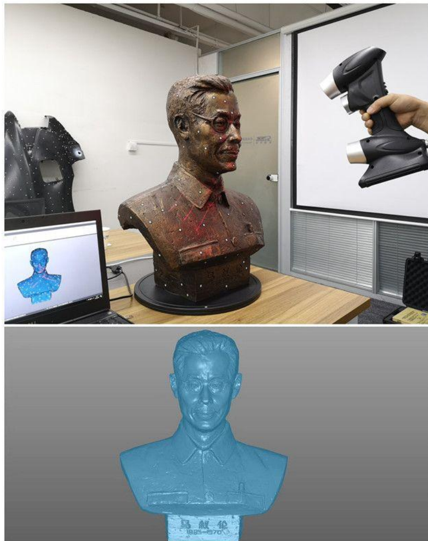
Slika 62: Skeniranje biste pomoću „ PRINCE 3D “ skenera 66
