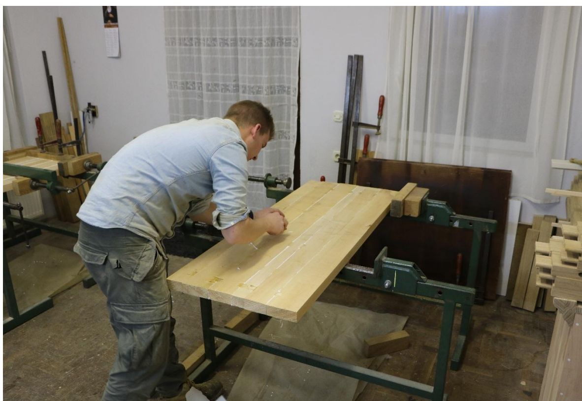
Slika 129: Mehaničko uklanjanje sasušenog viška ljepila
