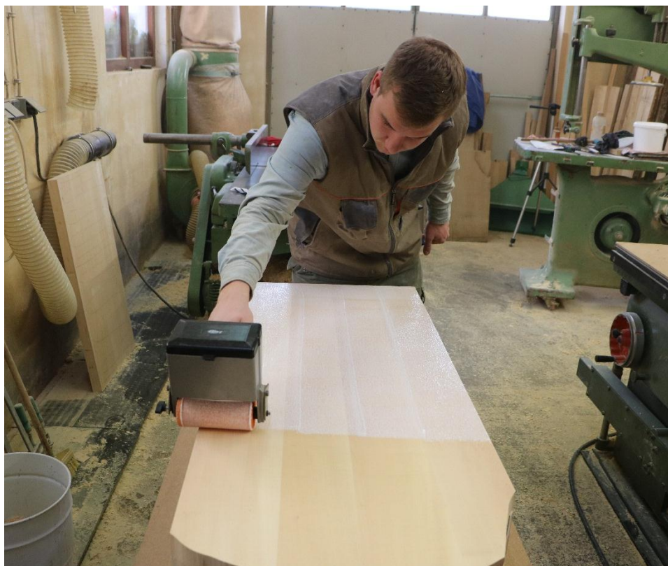
Slika 139: Nanašanje ljepila valjkom na ploče
