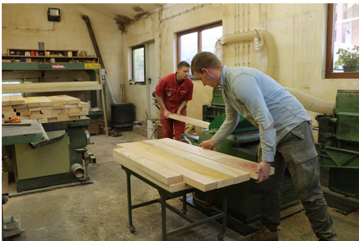
Slika 122: Svođenje svih dasaka na istu debljinu pomoću debljače
