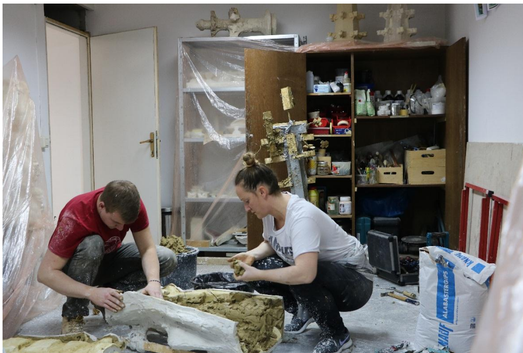
Slika 106: Vađenje komada gline iz gipsanog negativa
