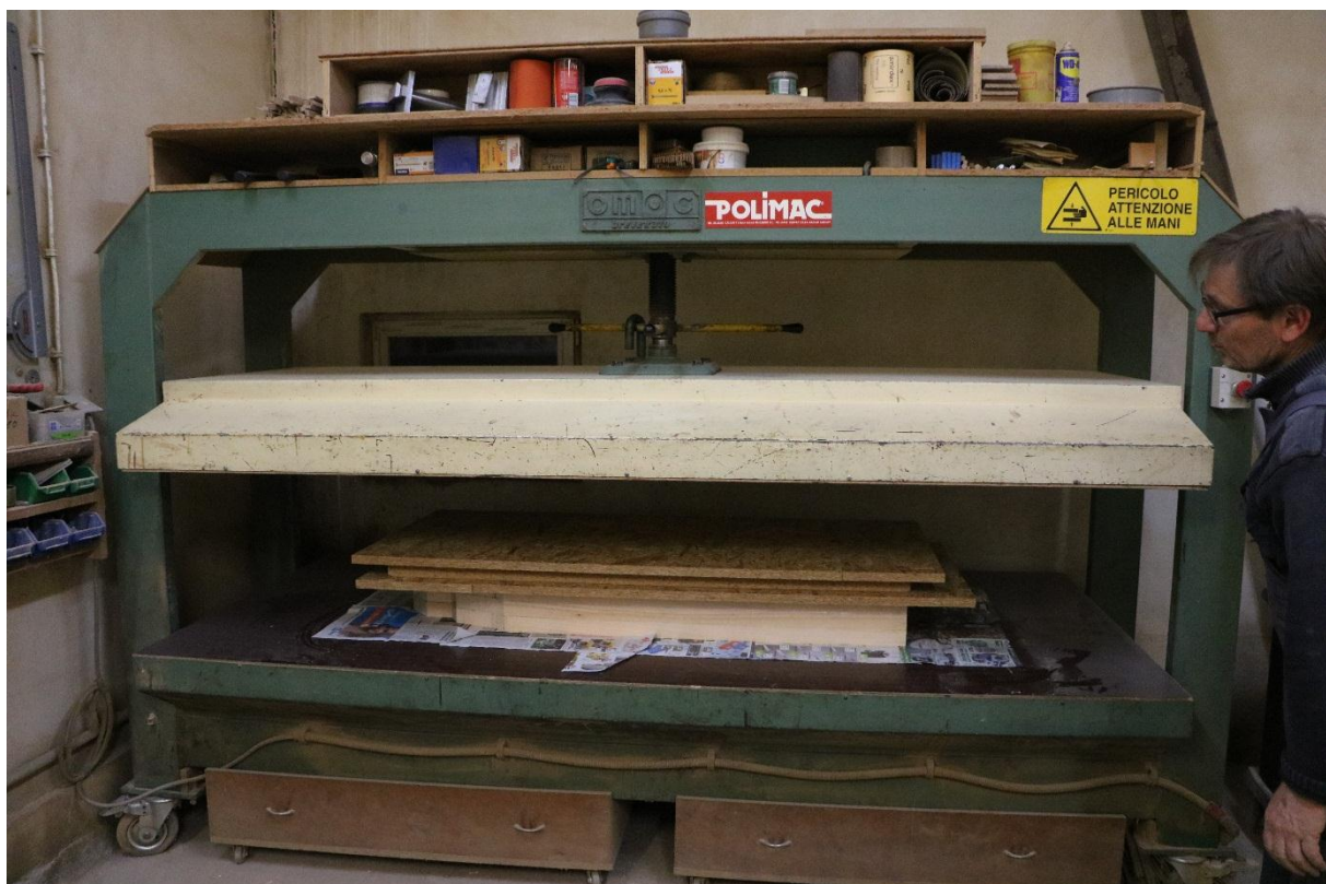
Slika 141: Elektromehanička preša za širinsko lijepljenje drva s dvije ploče
