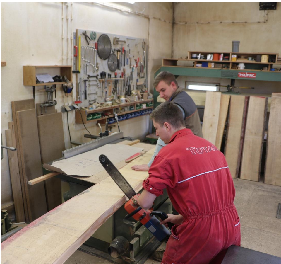
Slika 120: Rezanje fosne motornom pilom na željenu dužinu
