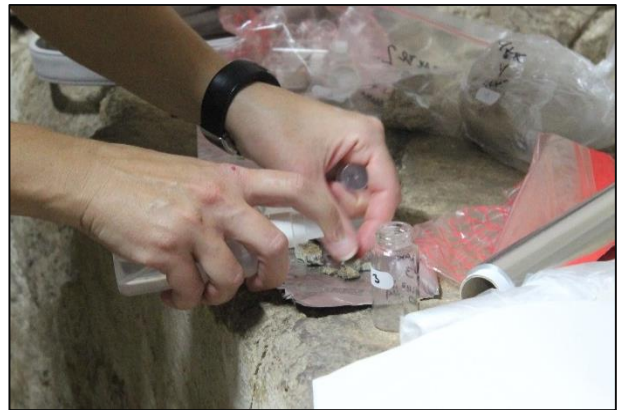
Slika 40. Test lužnatosti fenoftaleinom nakon uzimanja uzorka
