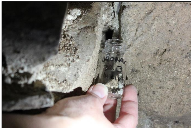
Slika 39. Uzimanje uzorka tamnosive žbuke s prve stepenice subseleije ranosrednjovjekovne crkve u podzemlju dubrovačke katedrale
