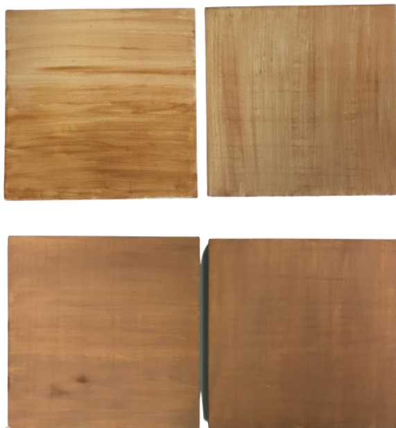
Slika 187. Testne pločice nakon nanesenog prvog sloja žutog polimenta, fotografirala Hana Knežević 2020.
