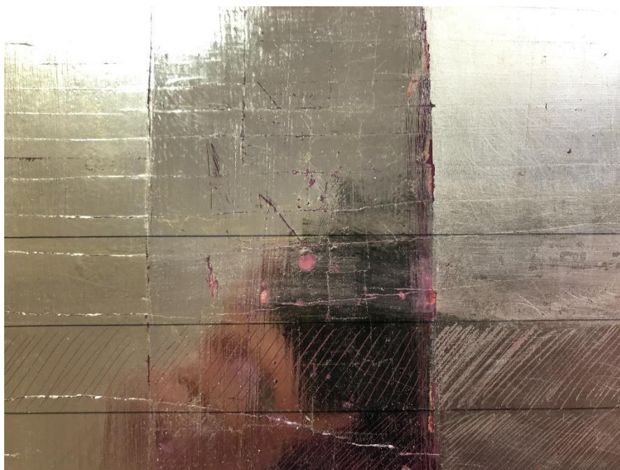
Slika 202. Test otpornosti na mehanička oštećenja, grebanje metalnim predmetom, fotografirala Hana Knežević 2021.
