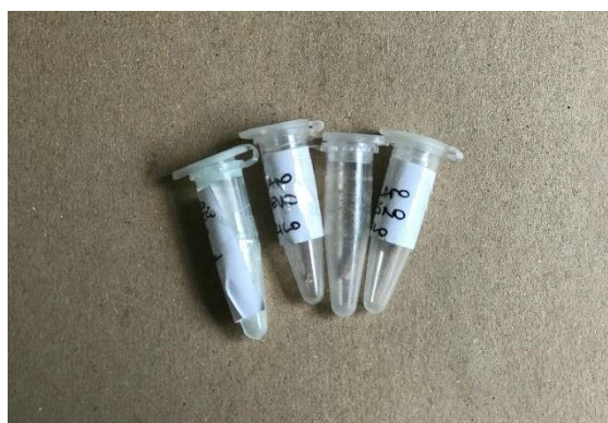
Slika 95. Mikro-uzorci pripremljeni za FTIR analizu, fotografirala Hana Knežević, 2019.
