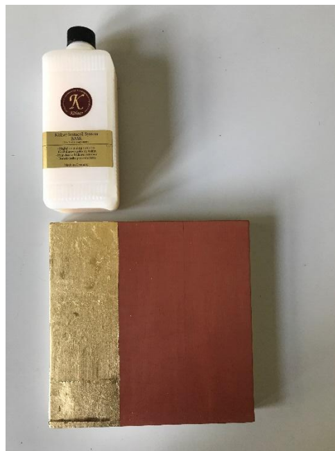
Slika 190. Testna pločica, zona br.1. premazana Kölner Instacoll System base , fotografirala Hana Knežević 2020.
