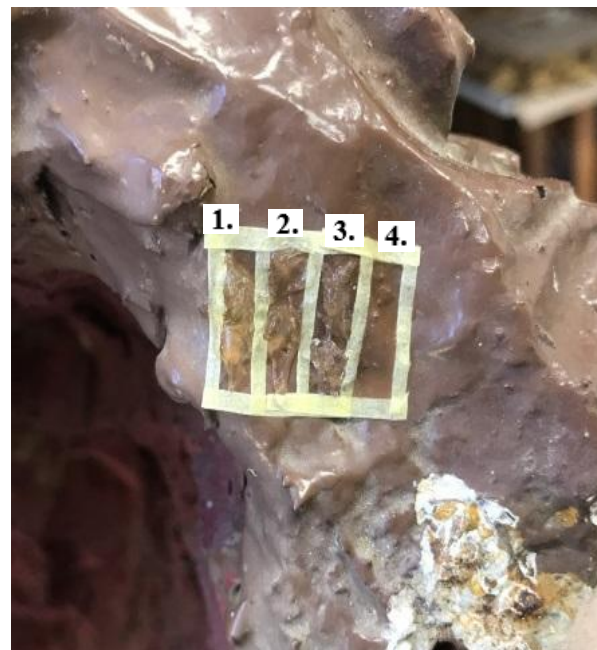
Slika 103. Probe uklanjanja preslika gelovima: (1)izopropanol gel, (2)DMSO, (3)Ethomen C-12 i (4)Paint & varnish remover, kosa, u tijeku radova, detalj, fotografirala Hana Knežević, 2020.
