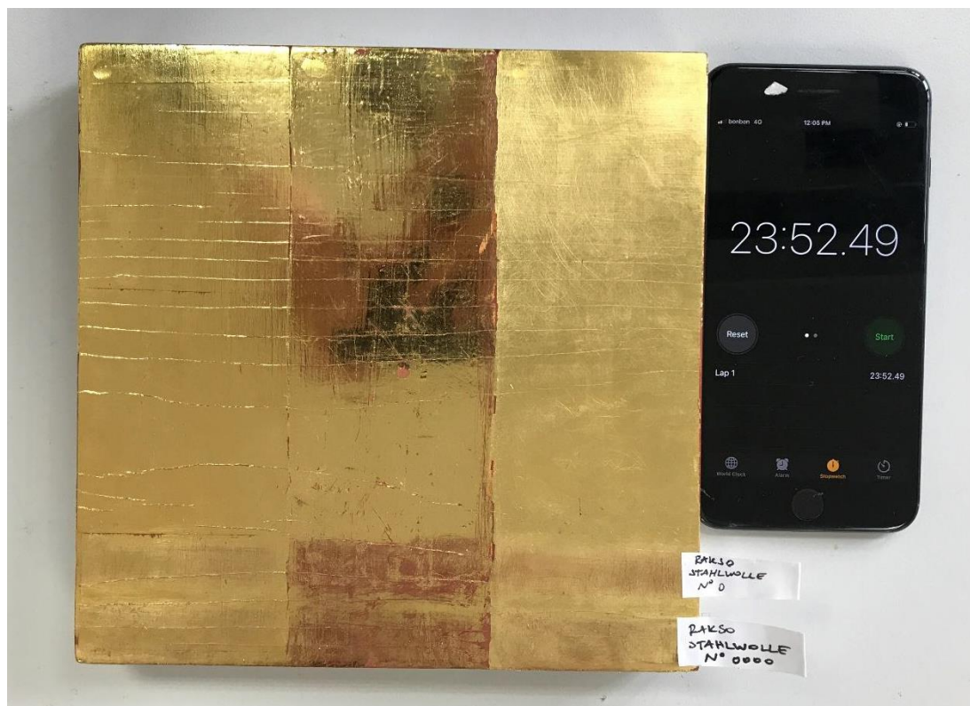
Slika 197. Test otpornosti na izravni utjecaj vlage, vrijeme upijanja kapljice vode u zoni br. 2, fotografirala Ana Božičević 2021.
