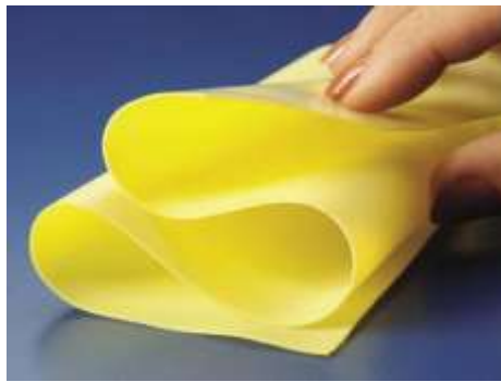
Slika 59: Savitljivi polimerni aerogel
