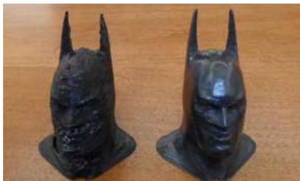
a) b) Slika 65: Primjer ispisa od a) PLA i b) ABS filameta
