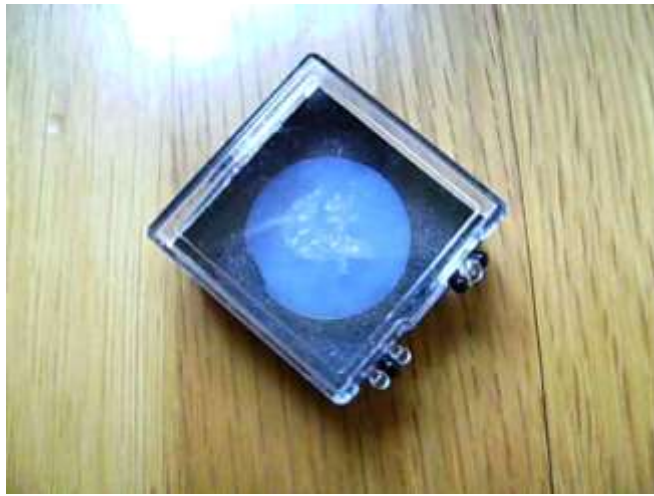
Slika 61: autor nepoznat, primjer izrade reljefa u silicijskom aerogelu
