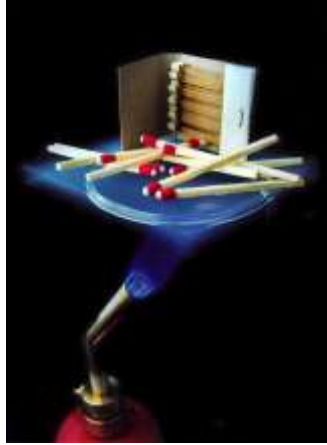
Slika 58: Aerogelom zaštićene šibice od plamena
