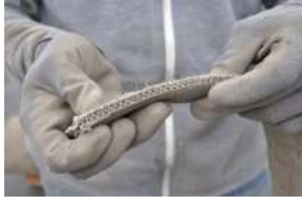
Slika 54: Presjek betonske tkanine
