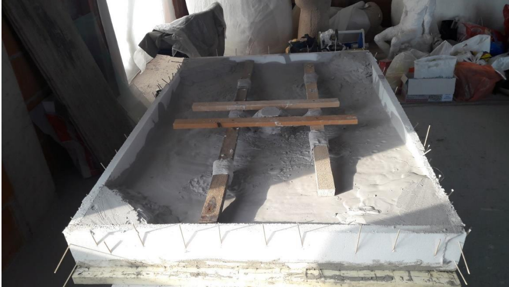
Sl. 19. Lijevanje gipsanog kalupa za papier-mâché
