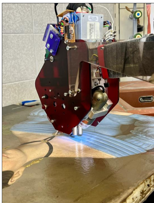
Slika 43. XRF analiza, ALU – OKIRU, snimila Iva Galijan, 2023.
