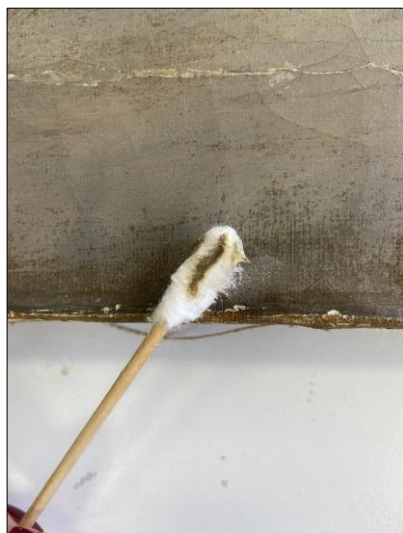
Slika 61. Izvođenje probe čišćenja tvrdokorne prljavštine Vulpexom otopljenim u white spirit -u (1:6), otklonjena prljavština vidljiva na vatom tamponu, snimila Iva Galijan, 2023.
