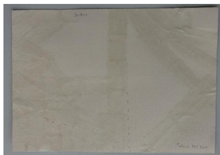
Slika 81: Rezultat proba podljepljivanja na testnom uzorku sitotiska, na desnoj polovici je korišteno celulozno ljepljivo ( Tylosa MH 300 ), a na lijevoj industrijsko škrobno ljepljivo ( Eukalin DK ), poledina (fotografirala Alma Šarić 27. 3. 2023.)
