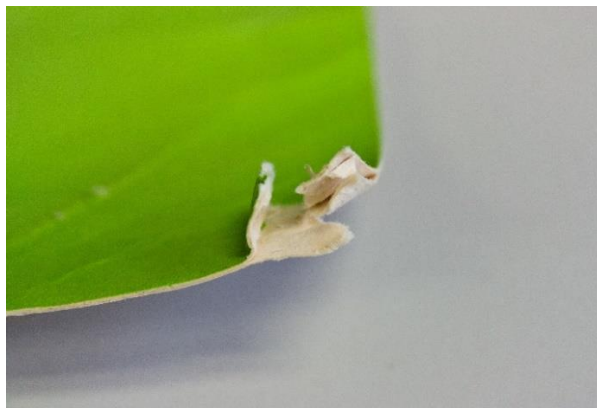
Slika 82: Simulacija nabora, poderotina i pregiba na testnom uzorku sitotiska, detalj (fotografirala Alma Šarić 27. 3. 2023.)
