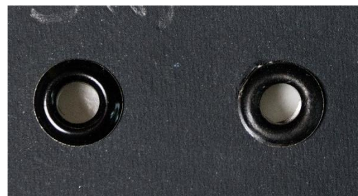
Slika 90: Rezultati proba lakiranja metalnih spojnice, lijevo je lak visokog sjaja, desno je mat lak (fotografirala Alma Šarić 30. 3. 2023.)
