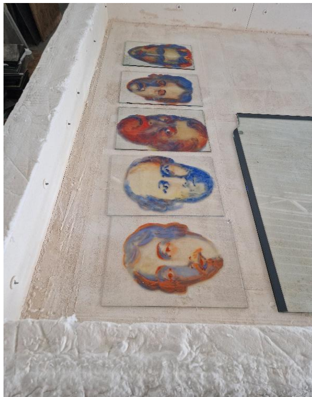
Slika 15: Prikaz stakala stavljenih u peć gdje slijedi pečenje na temperaturi od 600°C
