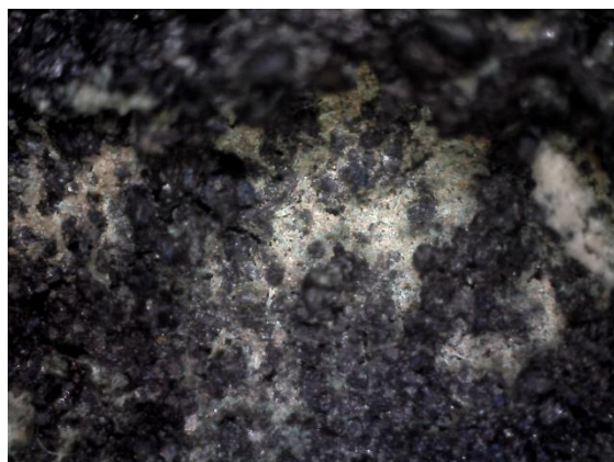
Slika 52. Kovanica A4, detalj, bijele naslage u korozivnoj kori, snimljeno Dino-Lite digitalnim mikroskopom
