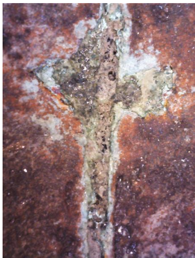
Slika 98. Kovanica B14, detalj korozije na aversu, snimljeno Dino-Lite digitalnim mikroskopom
