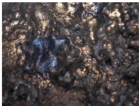
Slika 42. Kovanica A1, detalj, vanjski sloj korozivne kore, snimljeno Dino-Lite digitalnim mikroskopom
