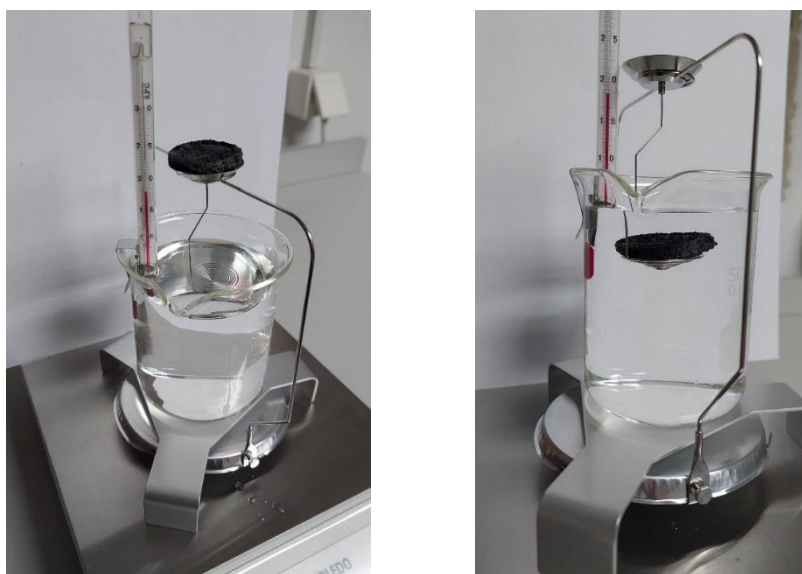
Slika 22. Mjerenje “suhe” mase i “mokre” mase kovanice A1, fotografirala: Judita Gracin, 1. 12. 2023.
