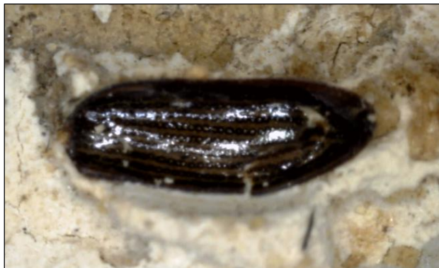
Slika 48. Pokrilje insekata Anobium Punctatum pod mikroskopom dino-lite, fotografirala: S. Knežević, ožujak 2023.
