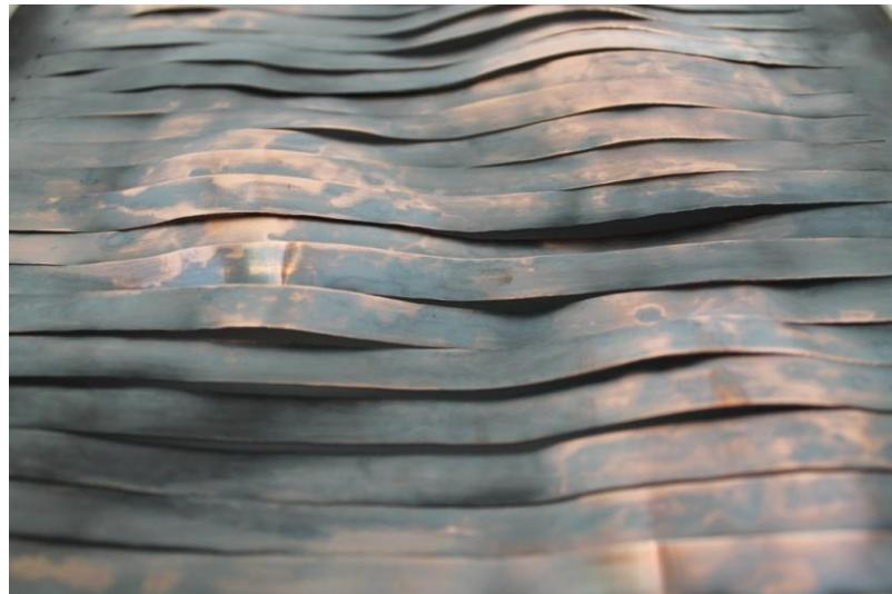
slika – primjer iskucane bakrene ploče drvenim puncama
