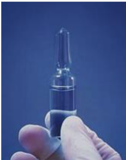
Sl. 4. Etanol-klorbenzenski dozimetar, ECB
