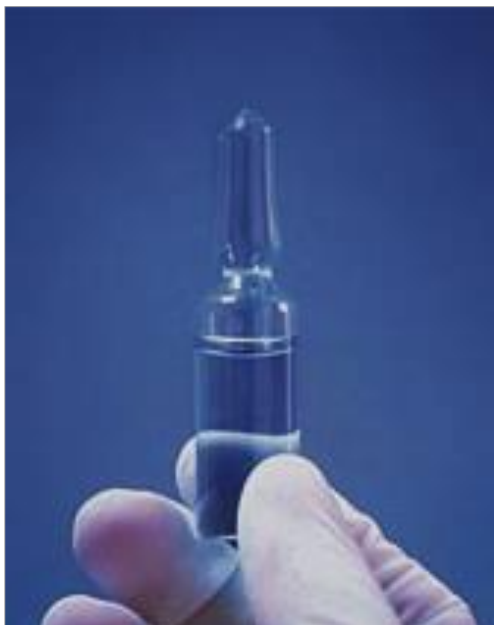
Sl. 4. Etanol-klorbenzenski dozimetar, ECB
