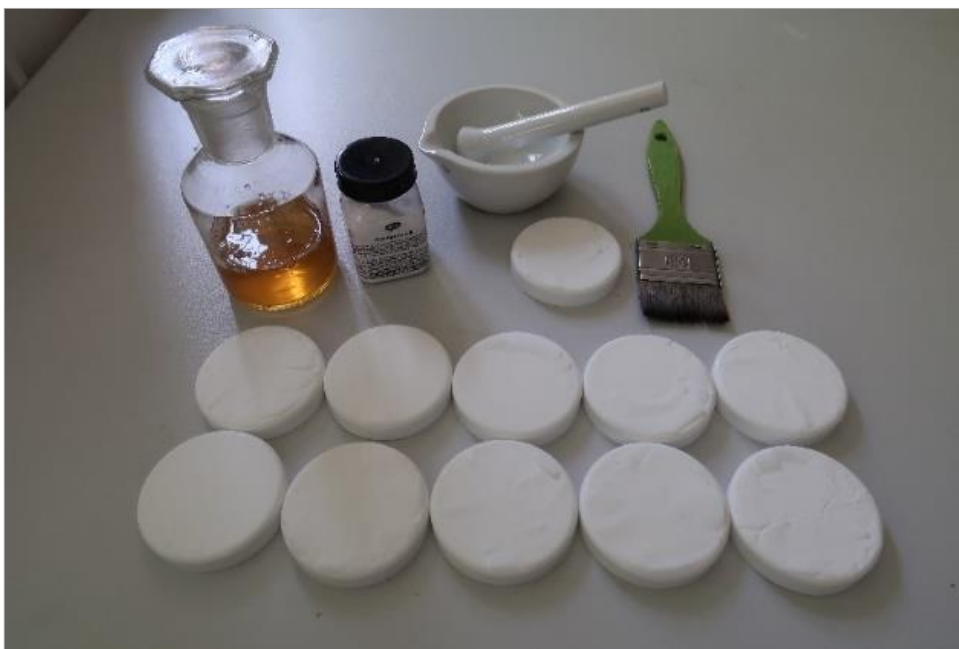
Sl. 36. materijali korišteni tijekom pripreme slikanog sloja za zračenje (na slici prikazana arapska guma kao vezivo)
