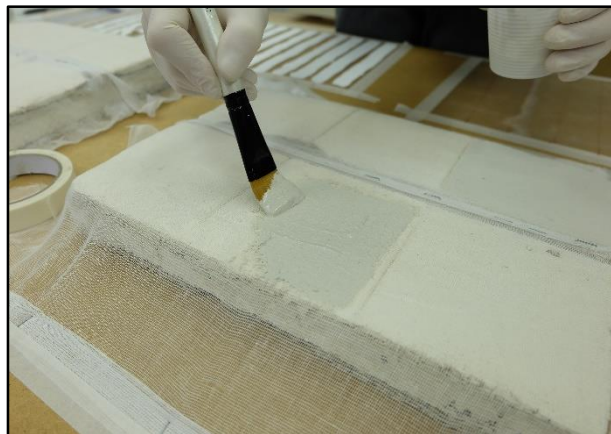
Slika 95. Nanošenje smjese PLM-AL na probne ploče
