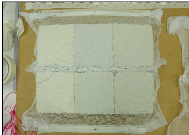
Slika 96. Probna ploča s recepturama PLM-AL 8, 8a i 8b koje su se pokazale najboljima
