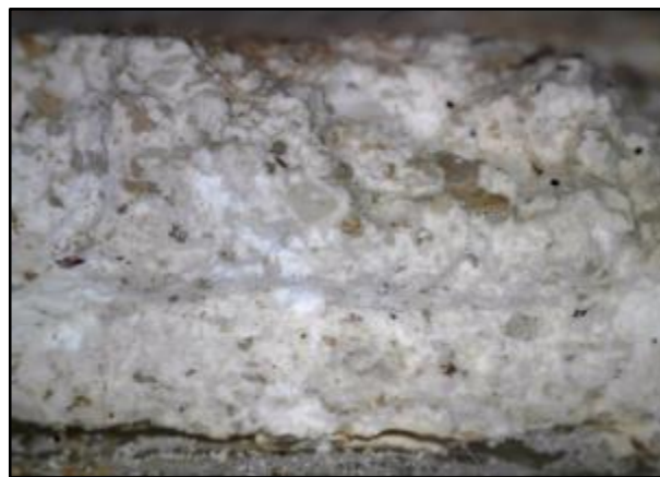
Slika 72. Detalj, uvećana fotografija stratigrafije žbukanih slojeva (presjek)
