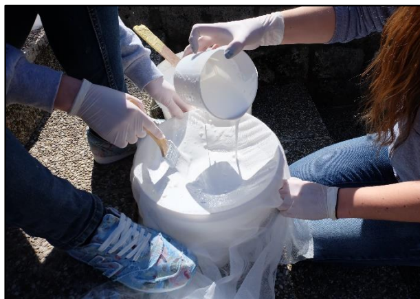
Slika 104. Priprema vapnenog kazeinata 4 : 1 : 1 – vapno : kazein : SOKRAT
