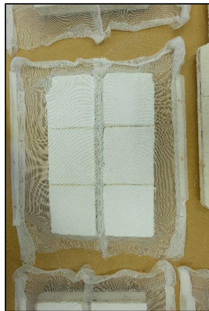
Slika 94. Probna ploča s recepturama vapnenog kazeinata 3, 3a, 3b, 3c i 3d koje su se pokazale najboljima
