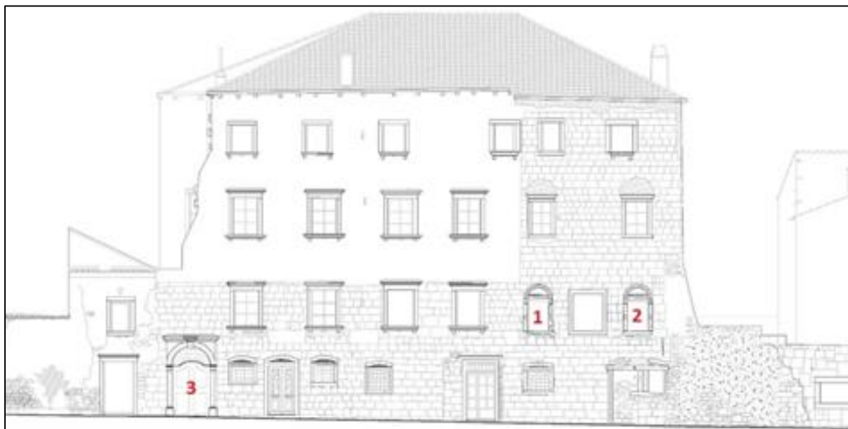
Slika 68. Arhitektonski snimak zatečenog stanja sjevernog pročelja kuće Moise 2010. godine. Brojevi 1 i 2 označavaju renesansne monofore na prvom katu. Brojem 3 označen je renesansni istočni portal sjevernog pročelja.
