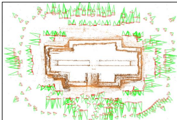
Slika 5. Zelenom bojom označeno je 510 položaja iz kojih je fotografirana površina oslika iz pred-hispaničke grobnice Las Higueras (Meksiko) u svrhu izrade 3D ortofotografije.
