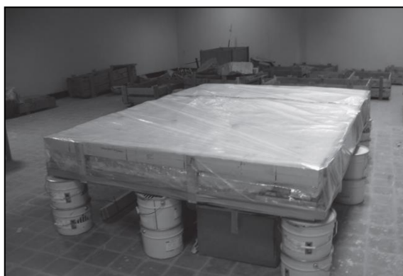
Slika 50. Odvojen fragment zidne slike temeljito umotan u prijanjajuću foliju kako bi se onemogućila sublimacija ciklododekana do nastavka radova.
