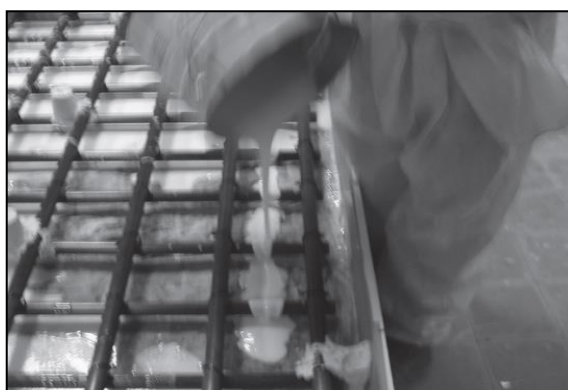
Slika 49. Lijevanje epoksidne pjene preko mreže od karbonskih cijevi.
