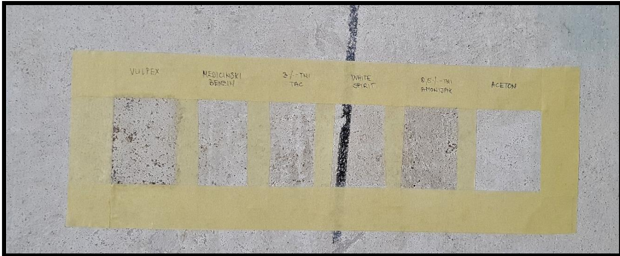
Slika 74 Probe čišćenja masnih mrlja na desnoj polovici oslika kod prikaza stupa
