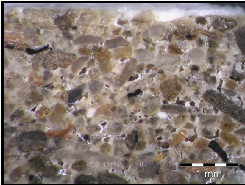
Slika 4. Mikrofotografija poprečnog presjeka uzorka žbuke lab. br. 24687 (reflektirano svjetlo)
