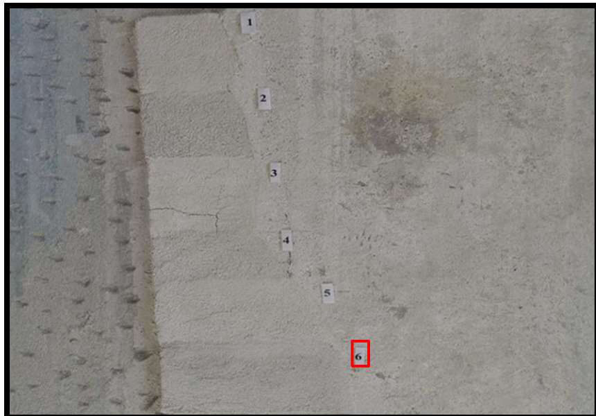
Slika 81 Detalj, proba žbuka na starijem sloju
