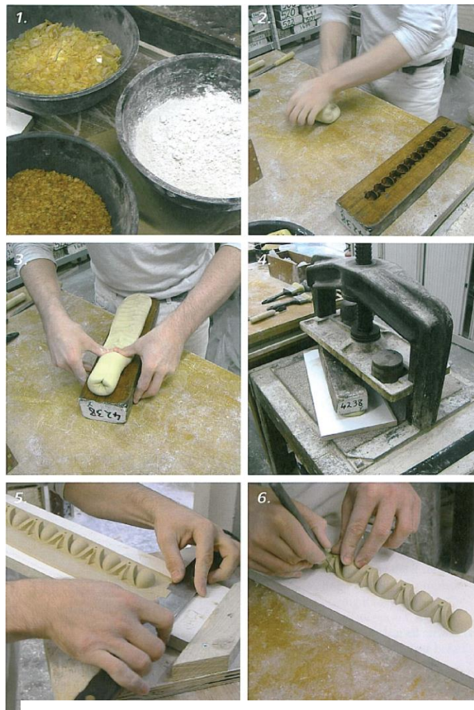
Sl. 129 - Utiskivanje kompozitne mase u drveni kalup
