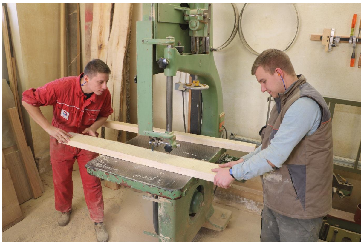
Slika 121: Rezanje fosni na tračnoj pili
