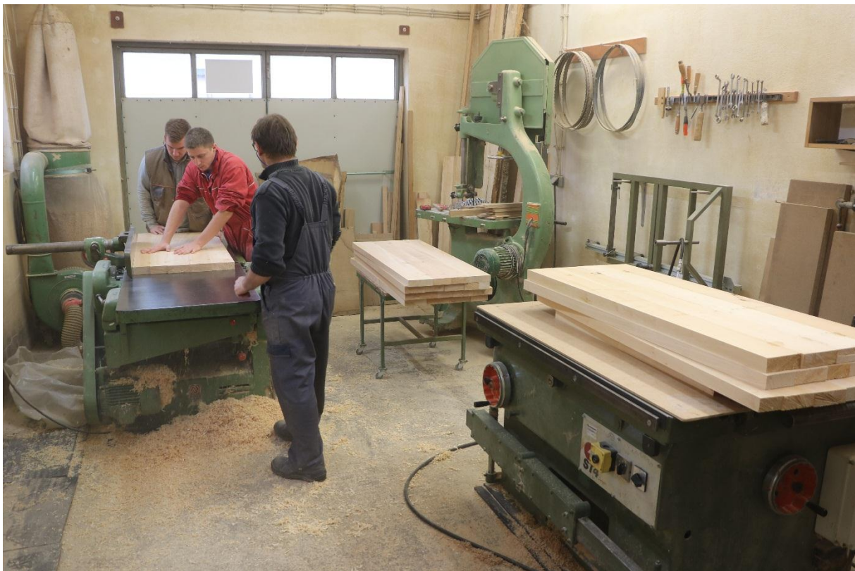
Slika 130: Ravnanje zalijepljenih lameliranih ploča
