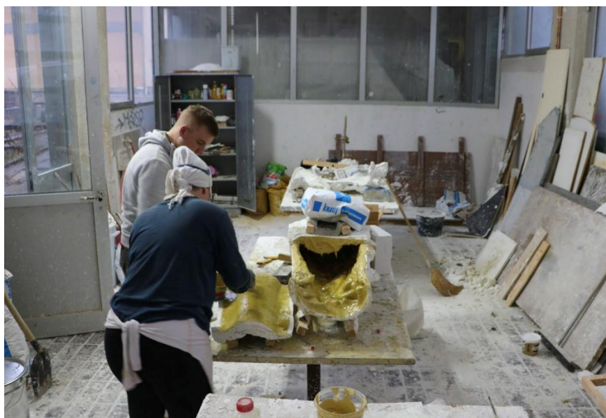
Slika 112: Završno spajanje kalupa i stavljanje poliesterske smole na rubove spoja
