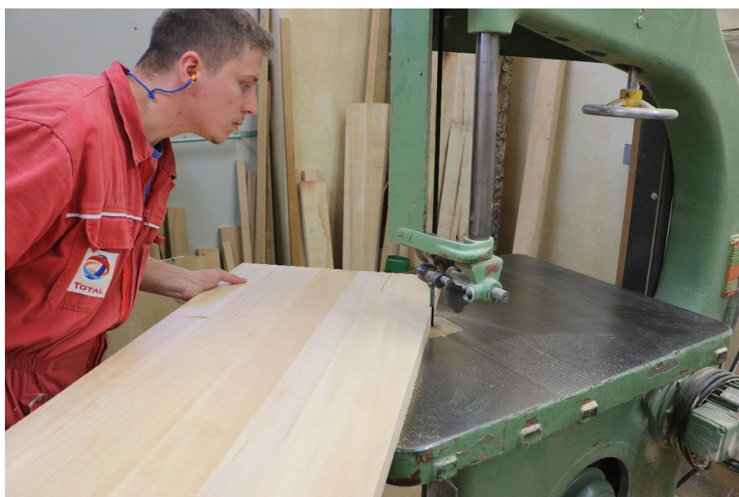
Slika 136: Rezanje ploča na tračnoj pili
