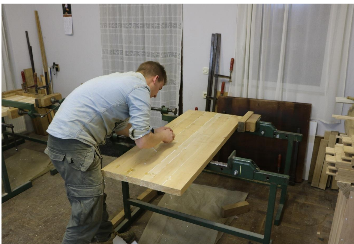
Slika 129: Mehaničko uklanjanje sasušenog viška ljepila
