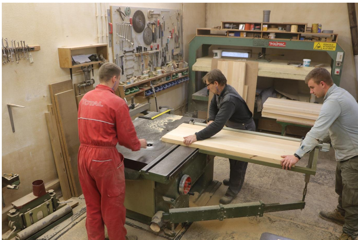
Slika 132: Rezanje ploča na stolnom cirkularu
