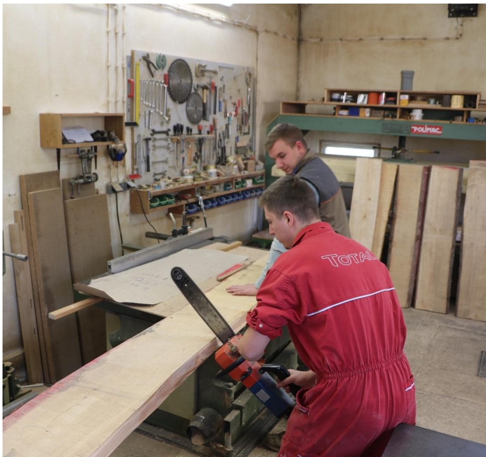
Slika 120: Rezanje fosne motornom pilom na željenu dužinu
