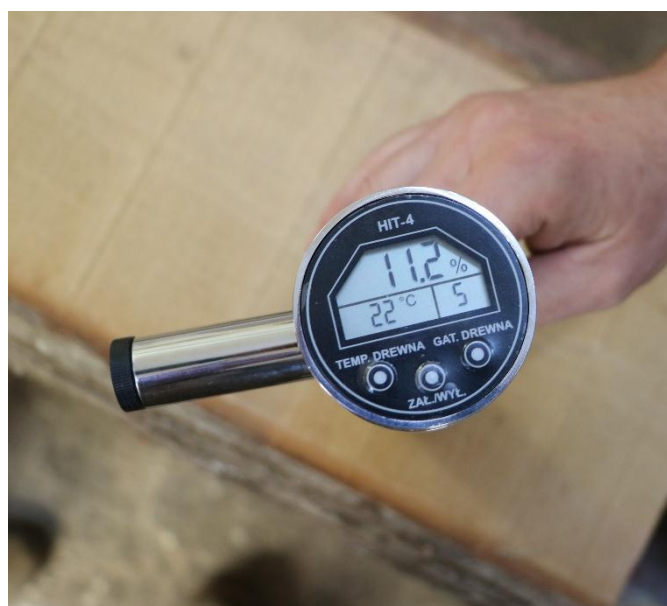
Slika 119: Prikaz pomoću vlagometra izmjerenih 11.2 % vlage u drvu
