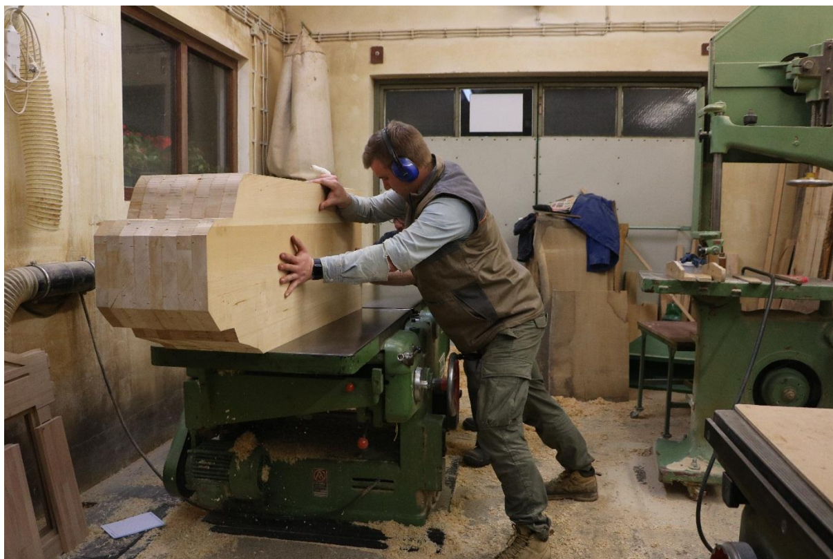
Slika 143: Završno ravnanje bočnih strana i nepravilnosti
