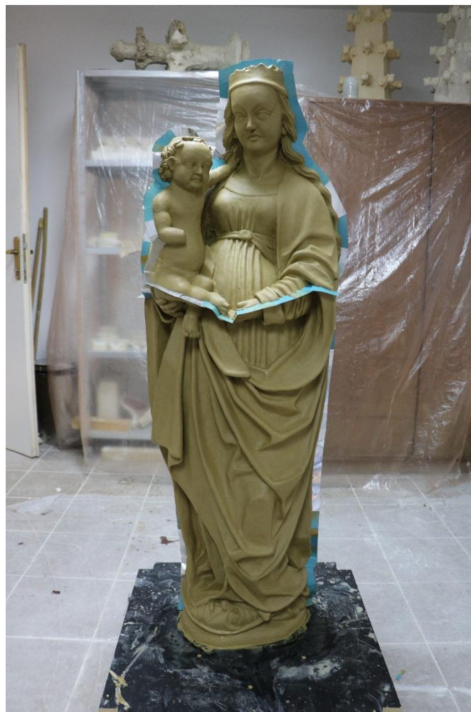
Slika 98: Pripremljeni limovi zabijeni u glinu, gornji i donji kalup
