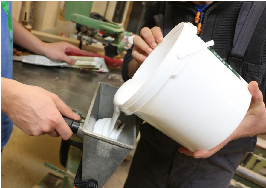
Slika 138: Ulijevanje ljepila u spremnik
