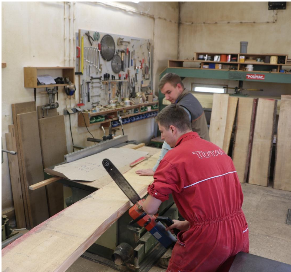
Slika 120: Rezanje fosne motornom pilom na željenu dužinu
