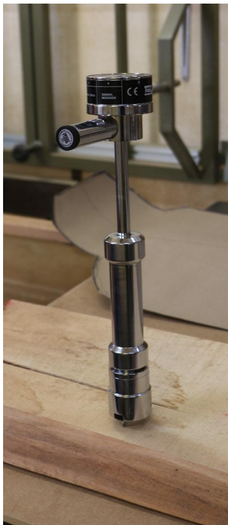
Slika 118: Vlagometar zabijen u fosnu koji očitava vlagu u drvu
