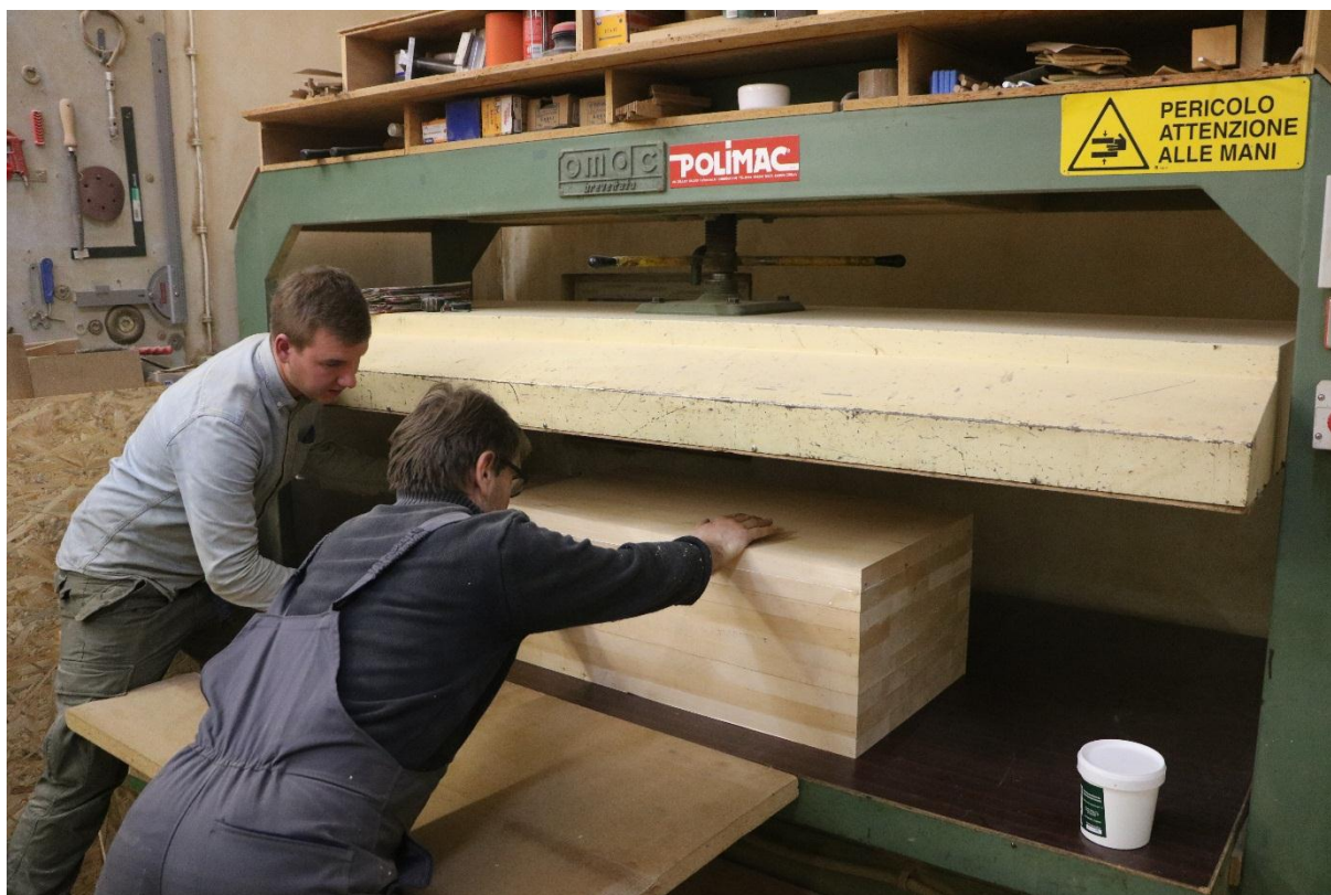
Slika 142: Stavljanje svih zalijepljenih ploča u prešu za završno stezanje
