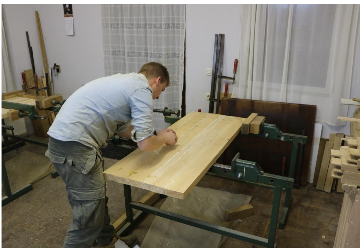
Slika 129: Mehaničko uklanjanje sasušenog viška ljepila
