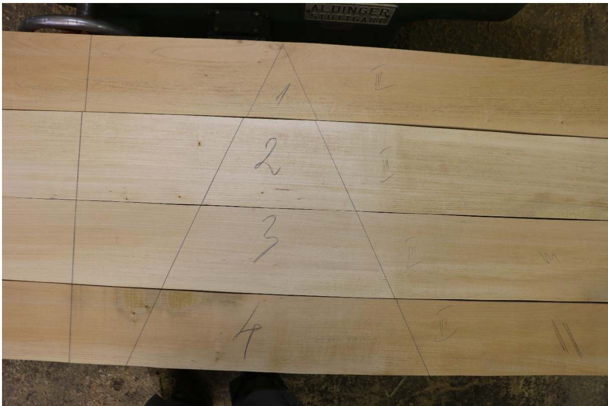
Slika 123: Nacrtani trokut i numerirane daske kako bi se znalo kojim redom se lijepi
