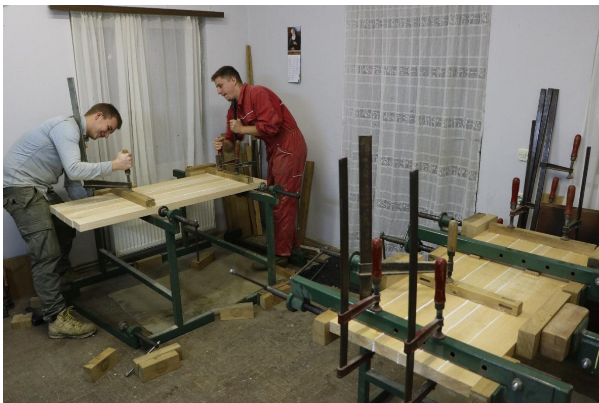
Slika 127: Ručno dotezanje stega (lijevo), stegnuta lamelirana ploča i vidljiv trag viška lijepila (desno)
