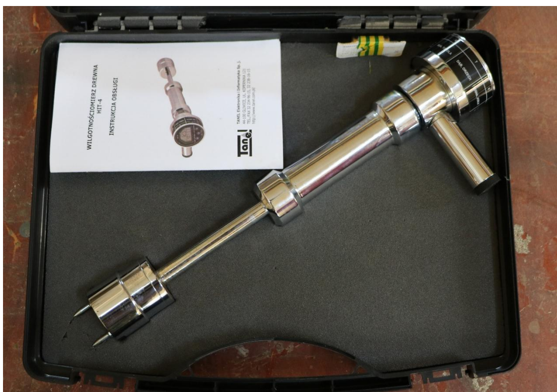
Slika 117: Vlagometar pomoću kojeg se vršilo mjerenje postotka vlage u drvu
