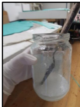
Slika 58. Vezivo - epoksidna smola
