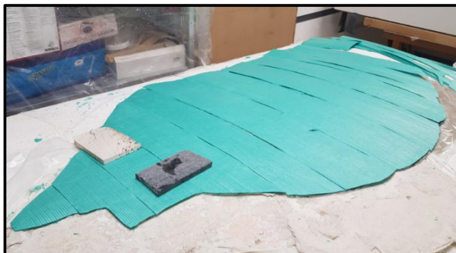
Slika 57. Polaganje iskrojjenih traka stirodura, cjelina
