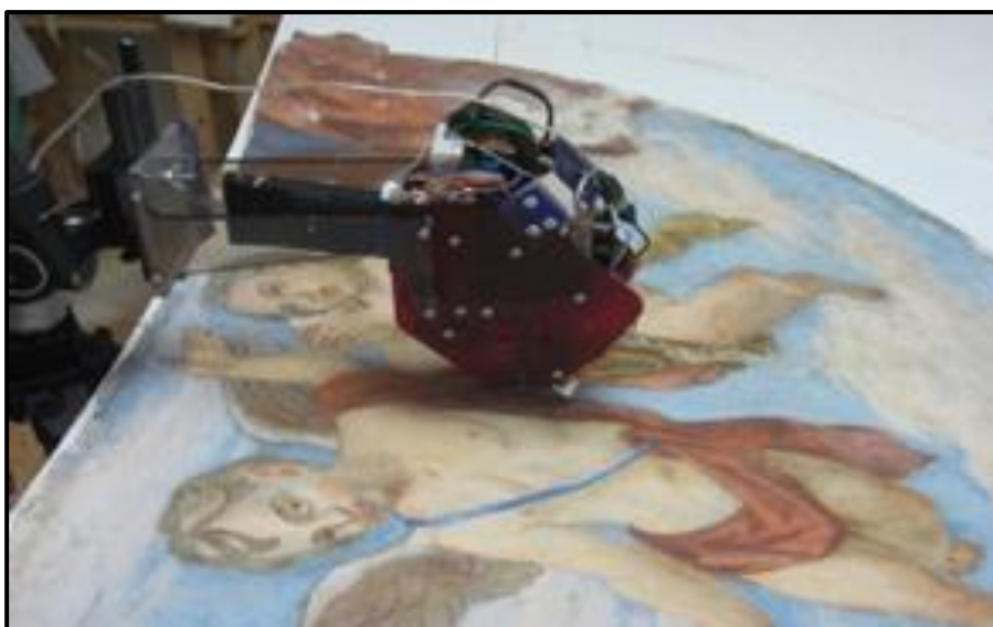
Slika 36. Analiza pigmenata XRF uređajem
