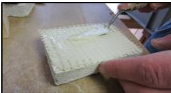
Slika 34. Priprema probnih pločica, uranjanje mrežice u PLM
