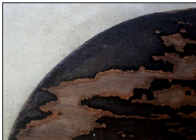
Slike br. 64 i 65 , prikaz konsolidiranog slikanog sloja, vidljiv zaostao masni trag, fotografirala Kristina Butković, 2017., OKIRU
