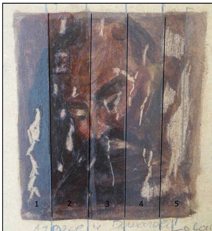
Slika br. 60 , prikaz prve probe koja je podijeljena na pet vertikalnih traka i na koju su nanešeni lakovi prema redosljed u tablici iznad
