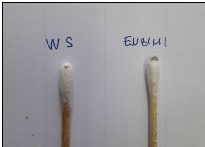
Slika br. 67 , probe čišćenja slikanog sloja, prikaz zaostale prljavštine na vatom štapiću, fotografirala Kristina Butković, 2017., OKIRU
