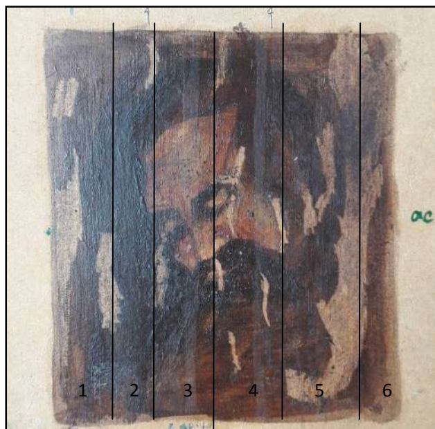
Slika br. 58 , prikaz prve probe koja je podijeljena na šest vertikalnih traka i na koju su nanešeni lakovi prema redoslijedu u tablici iznad, fotografirala Kristina Butković, 2017.
