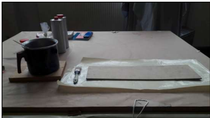
Slika br. 47 , aplikacija 10%-tnog koštanog tutkala u 2 sloja sa obje strane drva, fotografirala Kristina Butković, 2017., OKIRU
