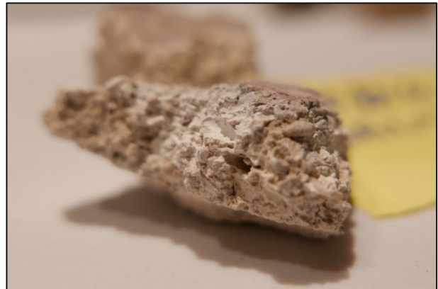
Slika 114. Analizirani uzorak bijele dvoslojne „romaničke“ žbuke
