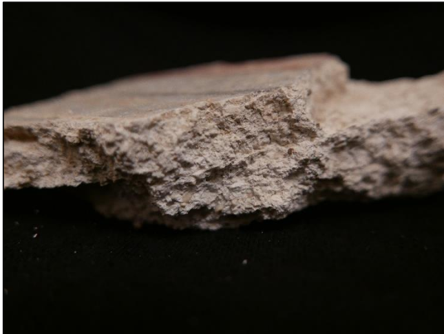
Slika 104. Ulomak dvoslojne romaničke žbuke, bočni presjek ulomka
