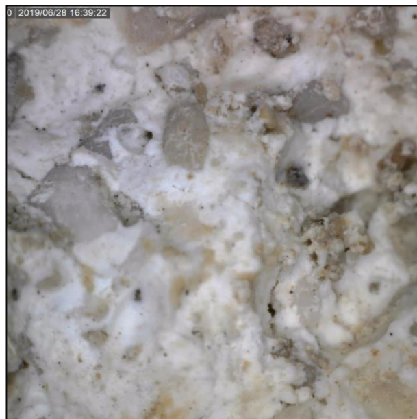
Slika 107. Dino-lite fotografija dvoslojne „romaničke“ žbuke
