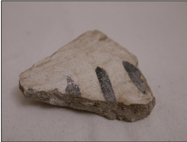
Slika 48. Ulomak s tamnosivom žbukom, lice
