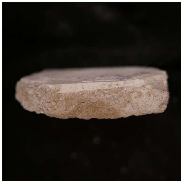
Slika 85. Ulomak s bijele sitnozrnate žbuke na tamnosivoj, bočni presjek
