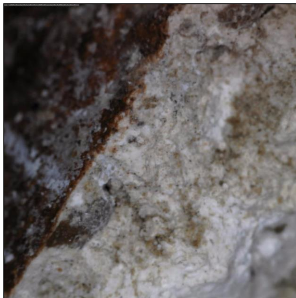
Slika 72. Dino-lite fotografije crvene žbuke s vidljivim oslikom
