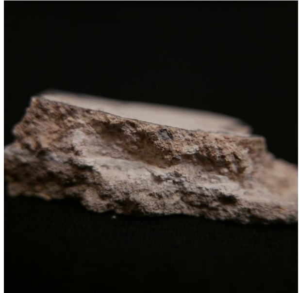
Slika 70. Ulomak na crvenoj žbuci, bočni presjek
