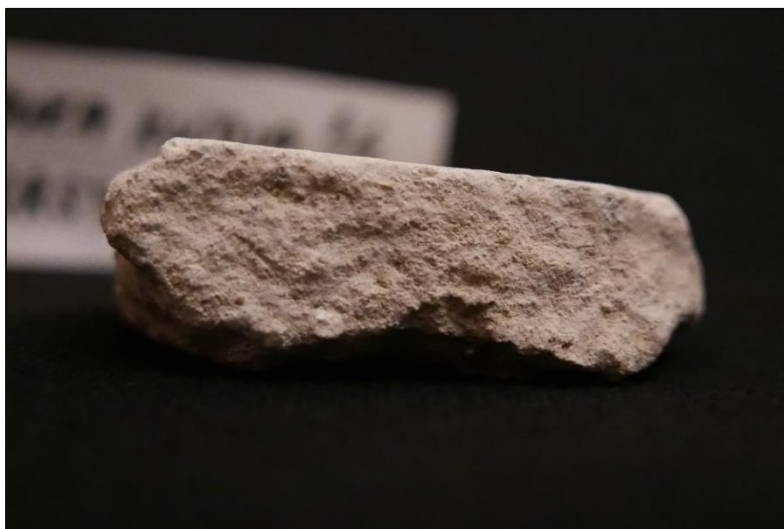
Slika 135. Ulomak sive, sitnozrnate lagane žbuke, bočni presjek ulomka s druge strane
