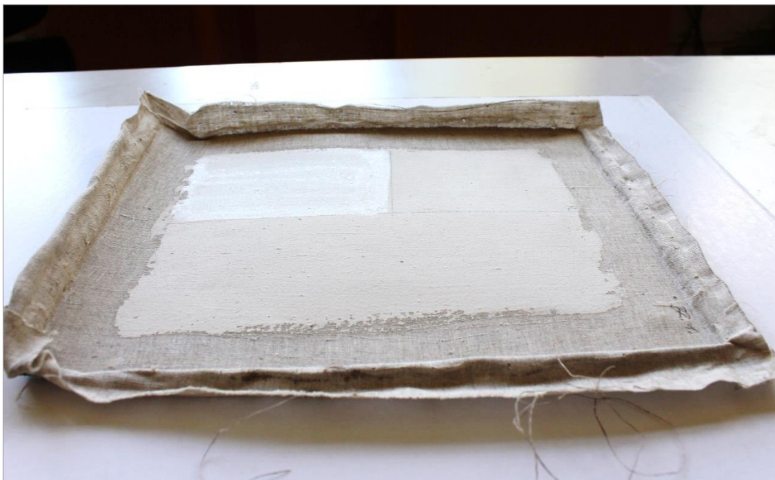
Slika br. 47 , odsjaj poledine simulacije slike „Dječak“ na koju je nanescna 5 i 10%-tna želatina
