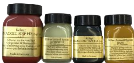
Slika 193. Kölner Instacoll proizvodi ( Base, Activator, Size HA ) korišteni tijekom ovog istraživanja, fotografirala Hana Knežević, 2021.
