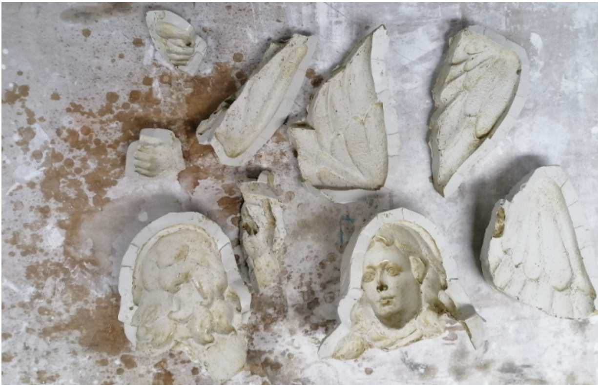
Slika 35. Prikaz očišćenih gipsanih kalupa. Snimila E. Baričević, 2020.
