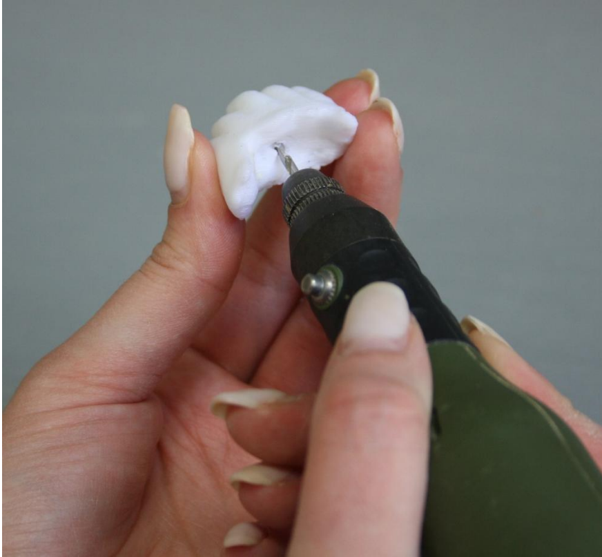
Slika 60. Bušenje rupe za tiplu na 3D modelu stopala malom ručnom bušilicom, dokumentirala: A. Šarić 2023.
