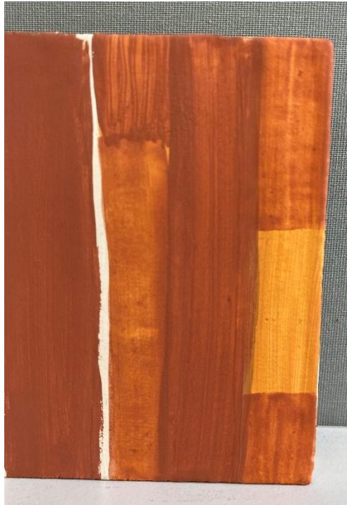
Slika 94. Probe bolusa na drvenoj pločici radi dobivanje odgovarajuće nijanse, dokumentirala: E. Baričević 2023.
