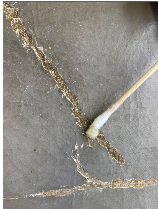
Slika 69. Dočišćavanje površine mješavinom acetona i medicinskog benzina (1:1), snimila Iva Galijan, 2023.
