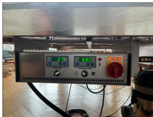
Slika 91. Postepeno dosizanje unaprijed određene temperature i vakuuma toplinskog stola, snimila Iva Galijan, 2023.
