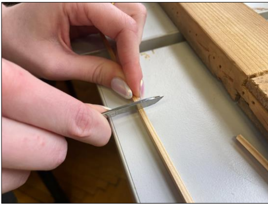
Slika 72. Adaptacija podokvira, prilagođavanje dužine drvenih letvica dužini bridova podokvira, snimila Kali Radojlović, 2023.
