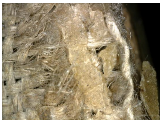
Slika 31. Nepoznati autor, Žena u plavoj haljini , 19. st., NMMU Zagreb, inv. br. OKIRU 438, prikaz niti izvornog nosioca i viška voska pod Dino-Lite mikroskopom, snimila Iva Galijan, 2023.
