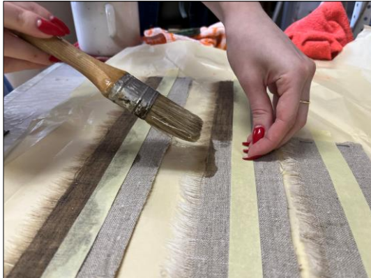
Slika 86. Nanošenje Beve 371 na trake za strip-lining , snimila Kali Radojlović, 2023.
