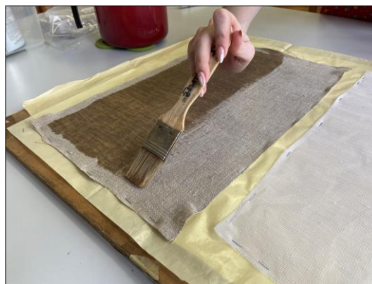
Slika 79. Probe kitova, tutkaljenje probnog platna, snimila Kali Radojlović, 2023.
