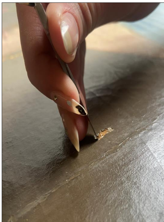
Slika 33. Uzimanje uzoraka kita za provedbu FT-IR analize, snimila Iva Galijan, 2023.
