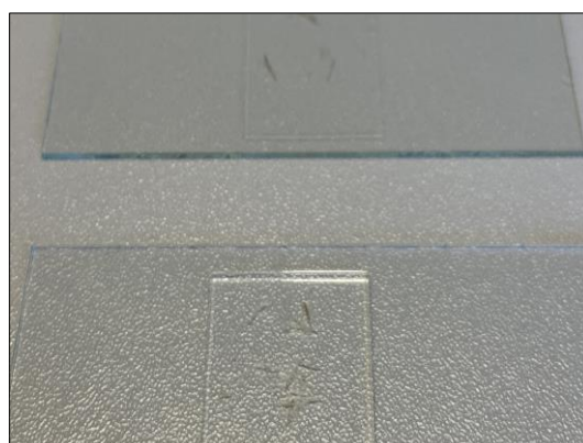
Slika 47. Razdvojena vlakanca položena na predmetna stakalca, spremna za mikroskopiranje, snimila Iva Galijan, 2023.
