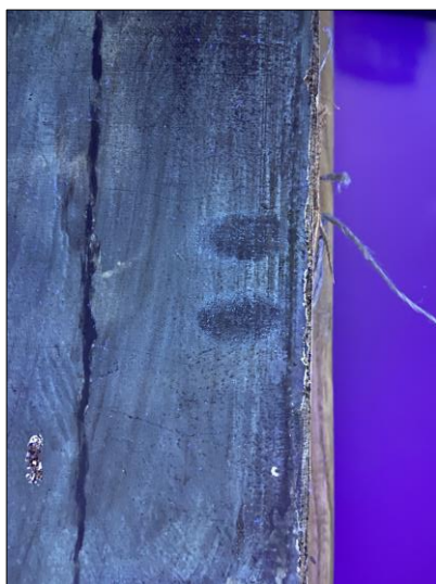
Slika 56. Probe uklanjanja laka mješavinom Shellsola T i etanola (3:7) (lijevo) i mješavinom Shellsola i etanola (5:5) (desno), fotografirano pod UV rasvjetom, snimila Iva Galijan, 2023.
