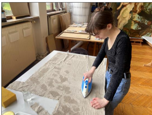
Slika 78. Probe kitova, ravnanje nabora prokuhanog probnog platna, snimila Kali Radojlović, 2023.
