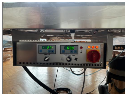
Slika 91. Postepeno dosizanje unaprijed određene temperature i vakuuma toplinskog stola, snimila Iva Galijan, 2023.
