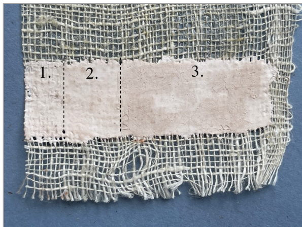
Slika 102. Proba kredno-tutkalnog kita nanesenog u više slojeva: 1. jedan sloj kita, 2. dva sloja kita, 3. 3 sloja kita, 2023.
