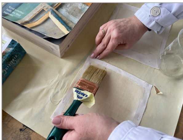
Slika 117. Aktivacija ljepila etil laktatom, 2023.
