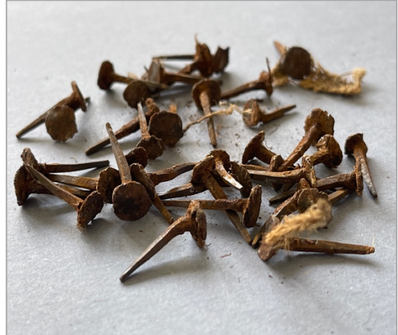
Slika 68. Prikaz izvornih čavala u dosta lošem stanju, 2022.
