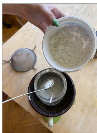
Slika 100. Dodavanje prosijane mješavine šampanjske i bolonjske krede u 7 %-tnu otopinu tutkala, 2023.
