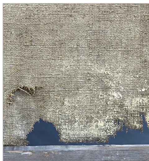
Slika 32. Nepoznati autor, Žena u kuhinji , inv. br. OKIRU 439, detalj poledine dublirnog platna, prikaz nepoznatog praškastog materijala bijele boje, 2022.
