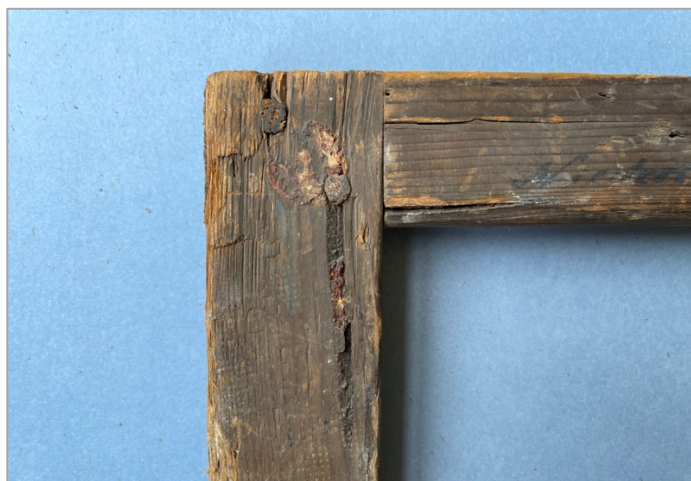
Slika 28. Nepoznati autor, Žena u kuhinji , inv. br. OKIRU 439, detalj podokvira, prikaz raspucanosti i pukotina na letvici koje prate godove drva, 2022.
