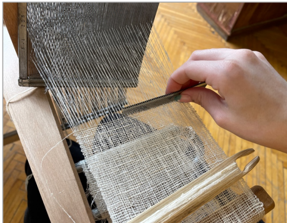
Slika 88. U tijeku tkanja lanenog platna na tkalačkom stanu, 2023.
