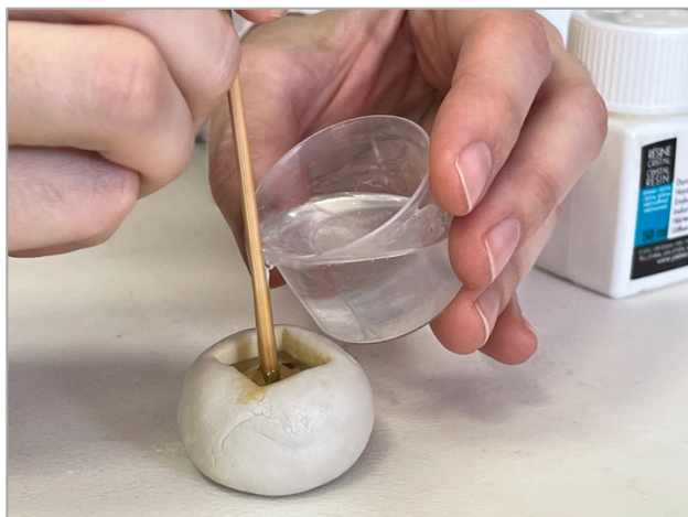
Slika 54. Ulijevanje mješavine epoxy smole u silikonski kalup, 2022.
