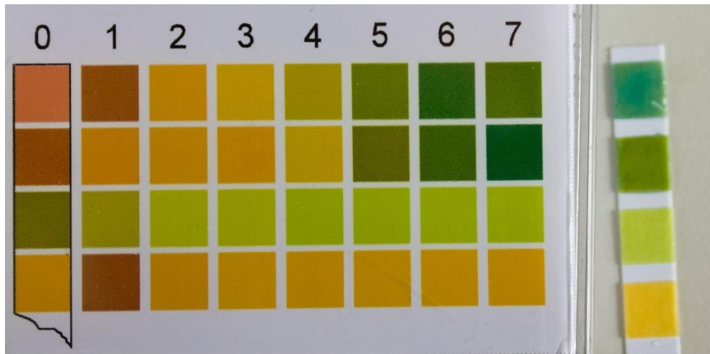
Slika 59: Usporedba referentne skale i korištene indikator trake (fotografirala Alma Šarić 27. 3. 2023.)
