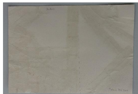
Slika 81: Rezultat proba podljepljivanja na testnom uzorku sitotiska, na desnoj polovici je korišteno celulozno ljepilo (Tylosa MH 300), a na lijevoj industrijsko škrobno ljepilo (Eukalin DK), poledina (fotografirala Alma Šarić 27. 3. 2023.)
