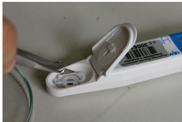
Slika 62: Agar gel postavljen na elektrode pH metra (fotografirala Alma Šarić 27. 3. 2023.)
