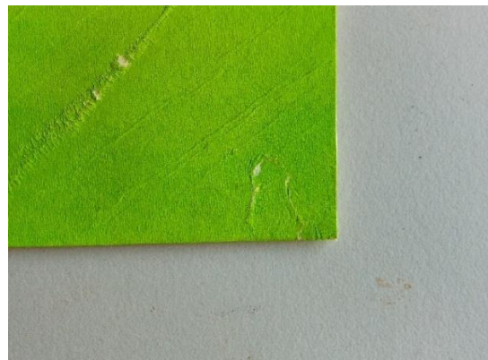
Slika 83: Rezultat probe podljepljivanja na testnom uzorku sitotiska, podlijepjeno celuloznim ljepilom (Tylosa MH 300), detalj, prednja strana (fotografirala Alma Šarić 27. 3. 2023.)
