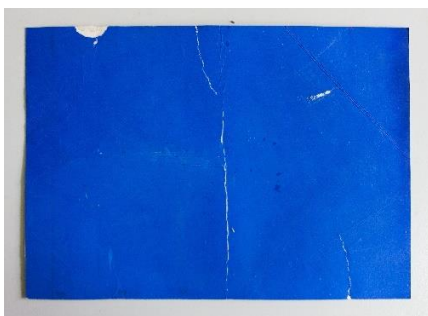
Slika 80: Rezultat proba podljepljivanja na testnom uzorku sitotiska, na lijevoj polovici je korišteno celulozno ljepilo (Tylosa MH 300), a na desnoj industrijsko škrobno ljepilo, prednja strana (fotografirala Alma Šarić 27. 3. 2023.)
