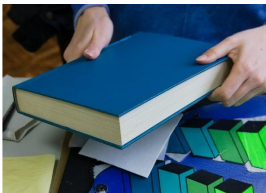
Slika 108: Podljepljivanje, postavljanje tereta na mjesto podljepljivanja (fotografirala Nera Brumen 5. 4. 2023.)
