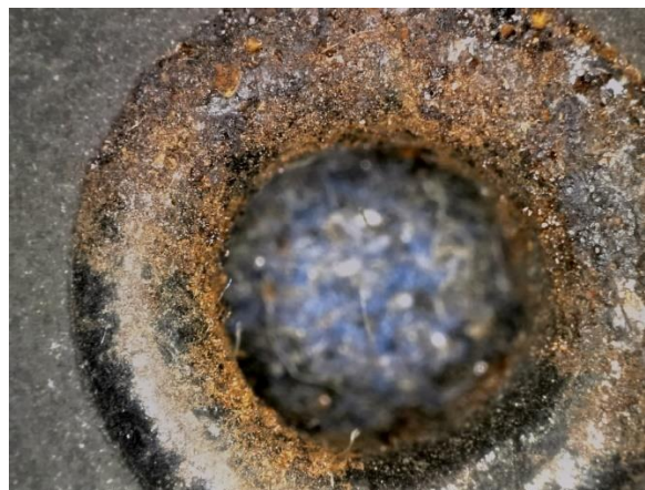
Slika 56: Miroslav Šutej, bez naziva, oko 1971. god., mobilna grafika, sitotisak, zatečeno stanje, detalj, prednja strana, makro fotografija, korozivni produkt na metalnoj spojnici (fotografirala Alma Šarić 16. 1. 2023.)
