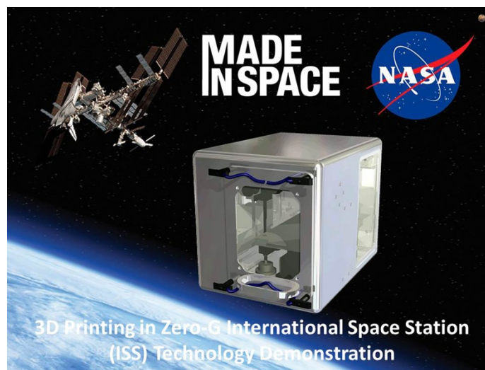
Slika 37: 3D printer dizajniran za uvjete bestežinskog stanja u svemiru Zemljine orbite, Međunarodna svemirska postaja, 2014.
