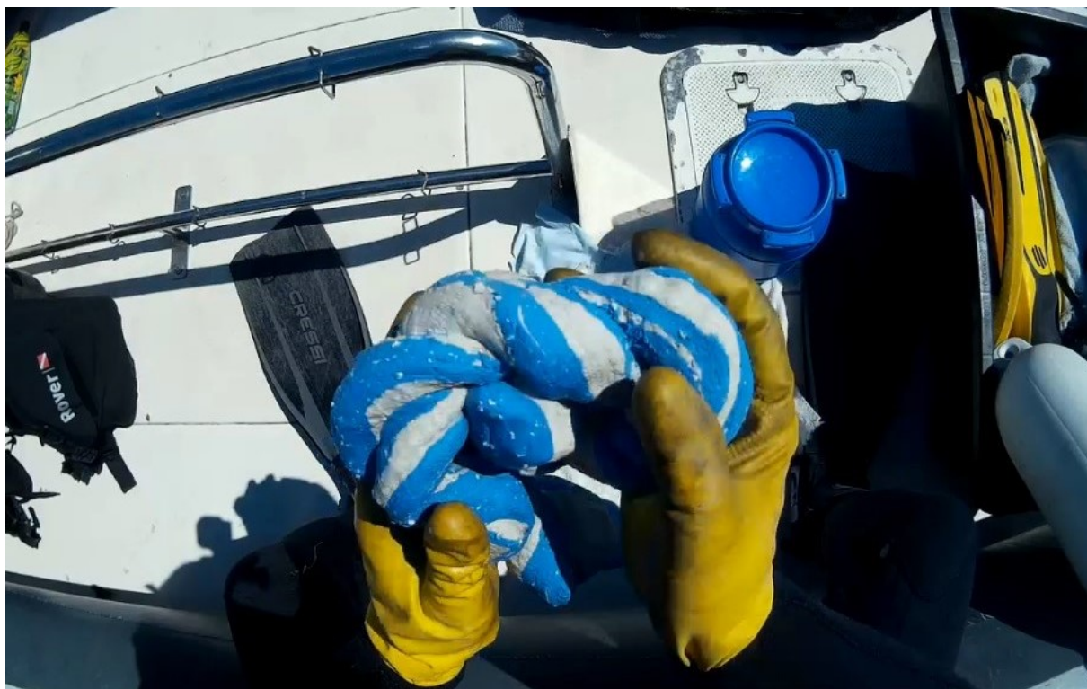
Slika 43: Gnječenje dviju komponenti materijala uoči zarona u more, grad Milna, otok Brač, 2016.
