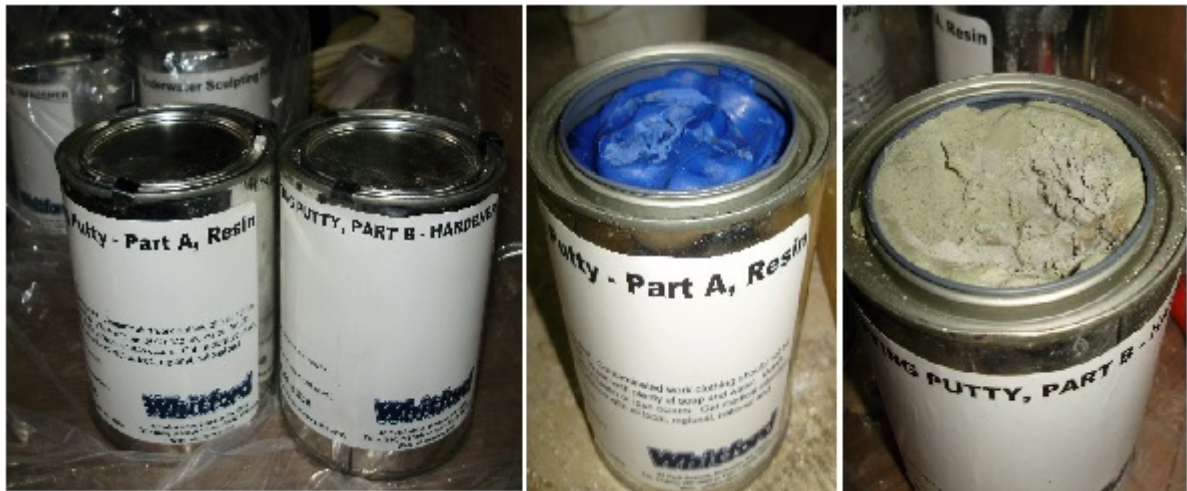
Slika 42: Dvokomponentni podvodni epoxy kit Aquamend, 2015.
