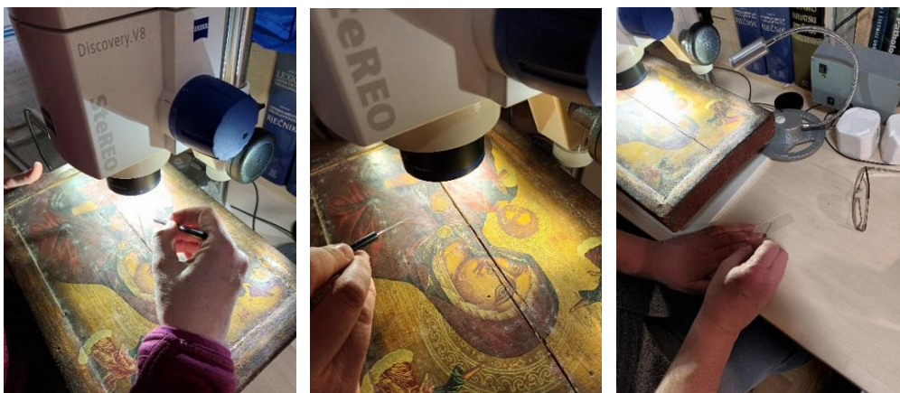
Slika 81. Proučavanje površine ikone „Bogorodica s Djetetom“ i uzimanje uzorka za mikroskopiranje (fotografirao Antun Škrlec, 23.3.2023.)
