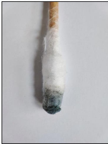
Slika 57. Prikaz pamučne vatiće nakon skidanja crnog preslika s acetonom
