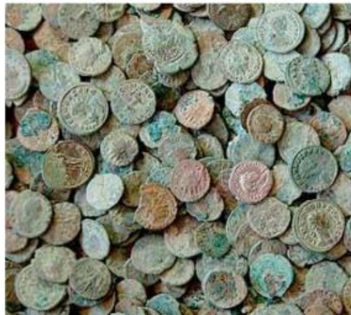
Slika 11. Zeleno-plavi slojevi malahita i azurita na tamno smeđem sloju kuprita, ŠATOVIĆ, D., Metalni materijali u kiparstvu - Skripta za konzervatore-restauratore, ALU Zagreb, 2020., 46.
