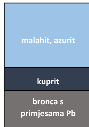
Grafički prikaz 11. Shema korozivskih slojeva na kovanicama B11 i B13
