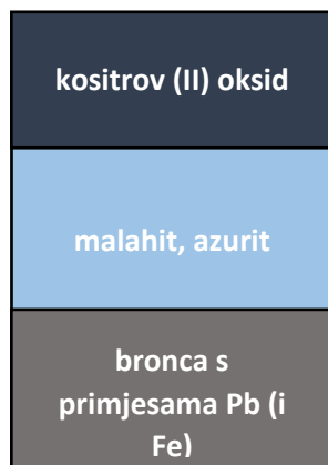
Grafički prikaz 10. Shema korozivskih slojeva na kovanici A5
